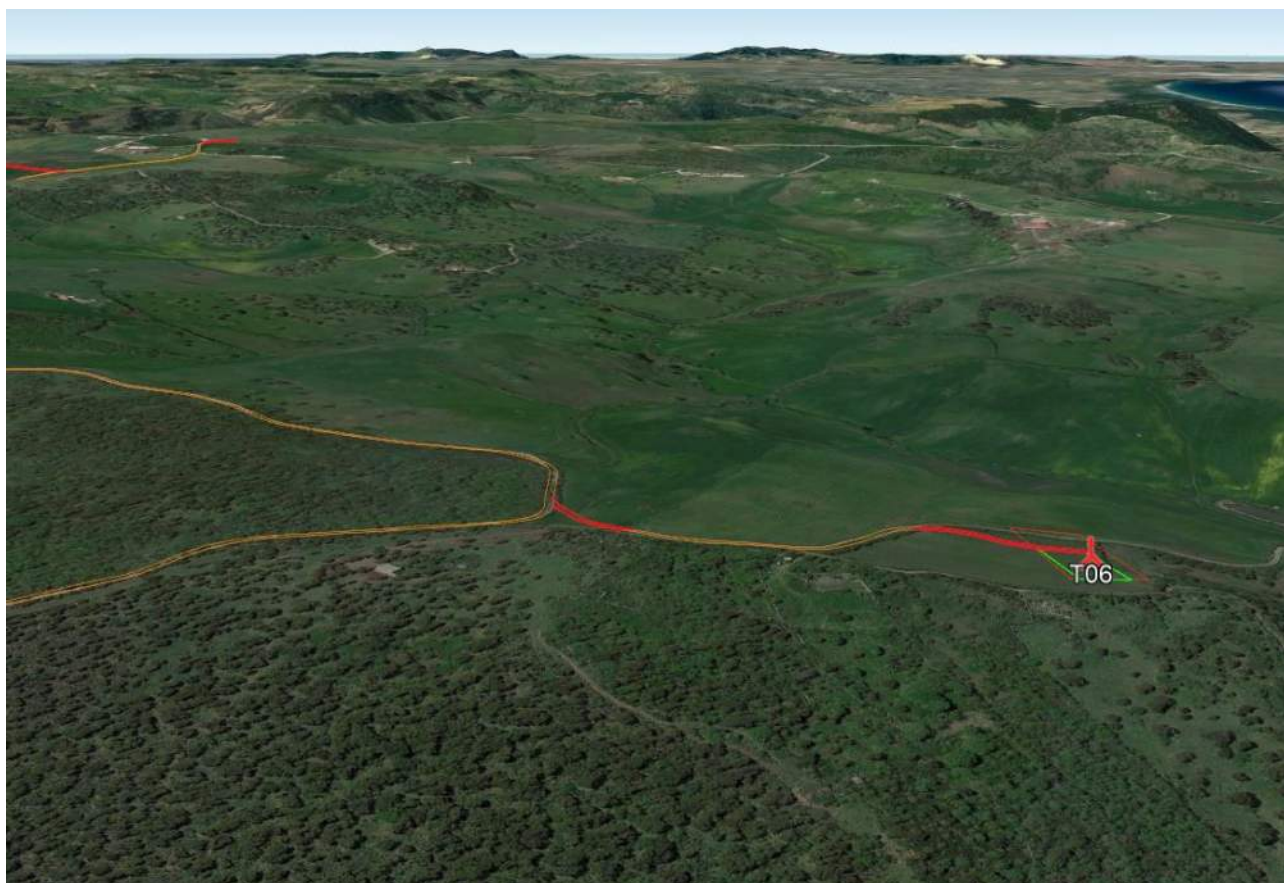
Figura 5.36 – Tracciato in adeguamento, a cui si alternano brevi tratti di nuova costruzione di collegamento alla postazione eolica T06 (vista verso ovest)
