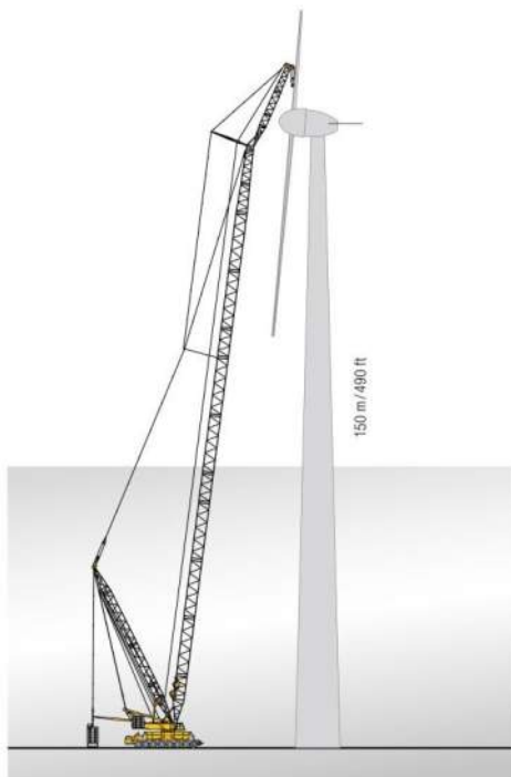
Figura 5.71 – Schema di una gru cingolata a traliccio con sistema derrick impiegata per l'innalzamento delle turbine eoliche dell'ultima generazione
