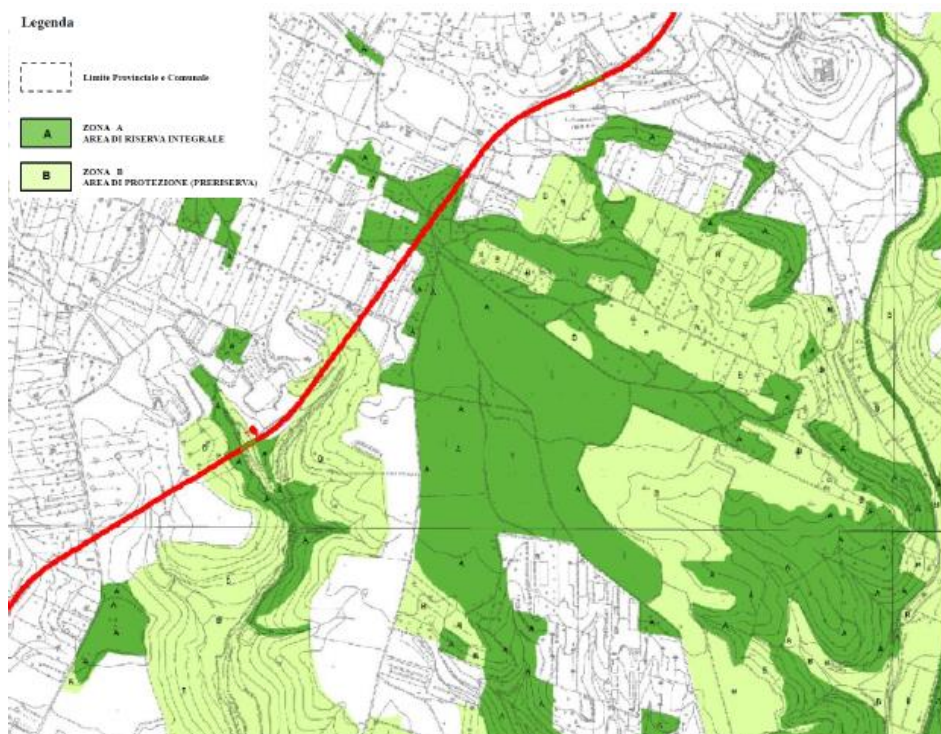
Figura 2-2-Perimetrazione della Riserva Naturale Orientata Sughereta di Niscemi in relazione al tracciato lungo cui si sviluppano gli interventi in oggetto. Fonte: https://www.comune.niscemi.cl.it/Amministrazione-Trasparente/Pianificazione-e-governo-del-territorio/nuova-perimetrazione-sughereta .
