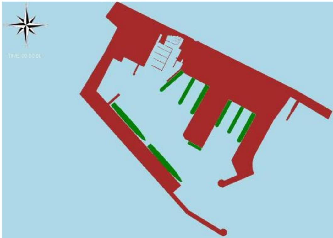
Figura 8-12: Layout 2D del Porto di Marina di Carrara nella situazione più gravosa in termini di navi all'ormeggio
