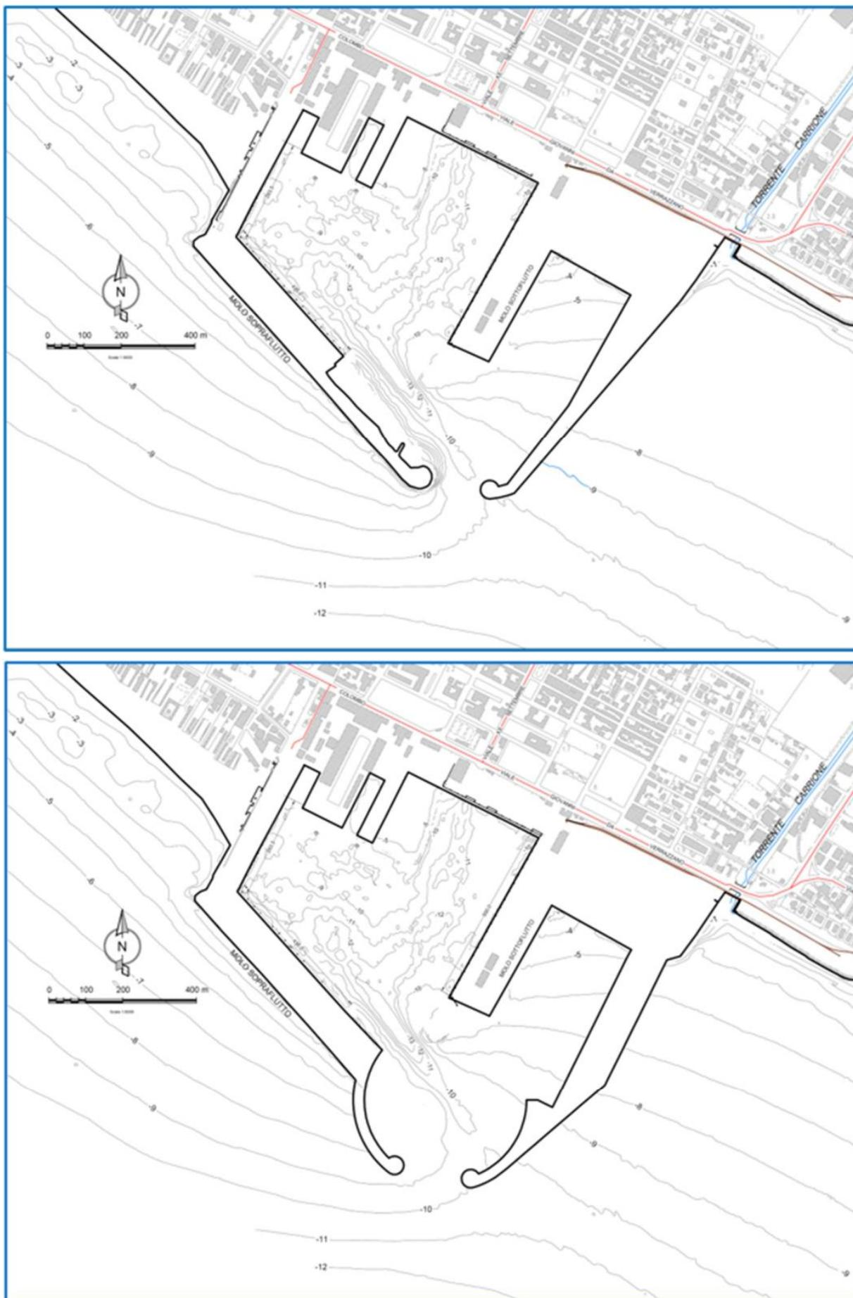
Figura 5-4: Layout B1 (sopra) e B2 (sotto) a moli convergenti
