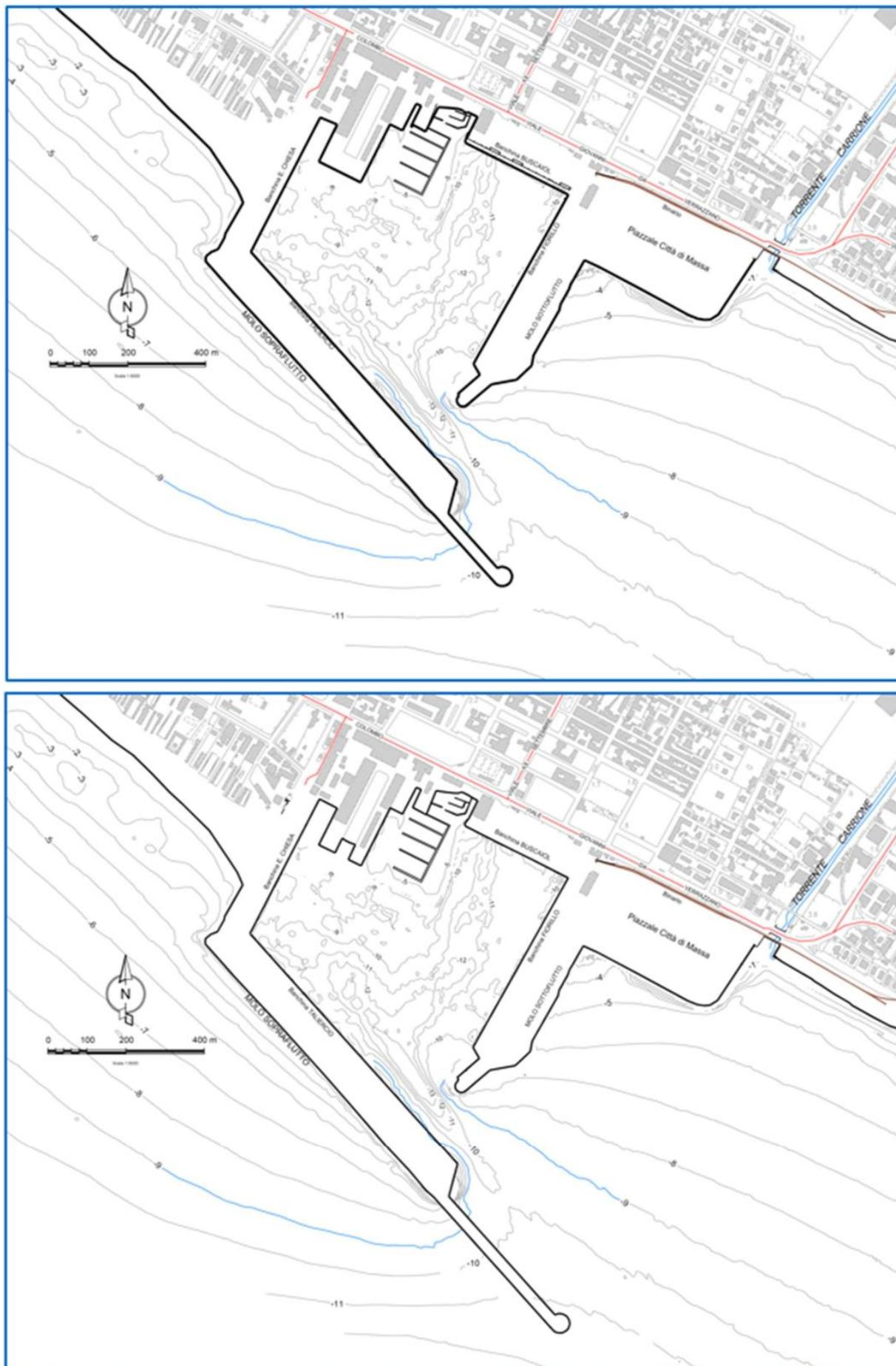
Figura 5-2: Layout AA1 (sopra e AA2 (sotto) con solo prolungamento del molo di sopraflutto
