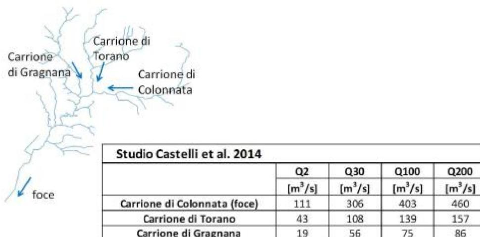
Figura 3-13. Valori massimi delle portate stimate nei rami principali della rete per i diversi periodi di ritorno ([Castelli et al. (2014)])
