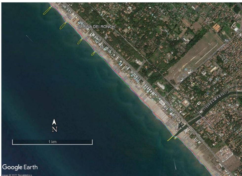
Figura 3-34. Dettaglio delle linee di riva (2010-2020) a Marina dei Ronchi in presenza dei pennelli di difesa
