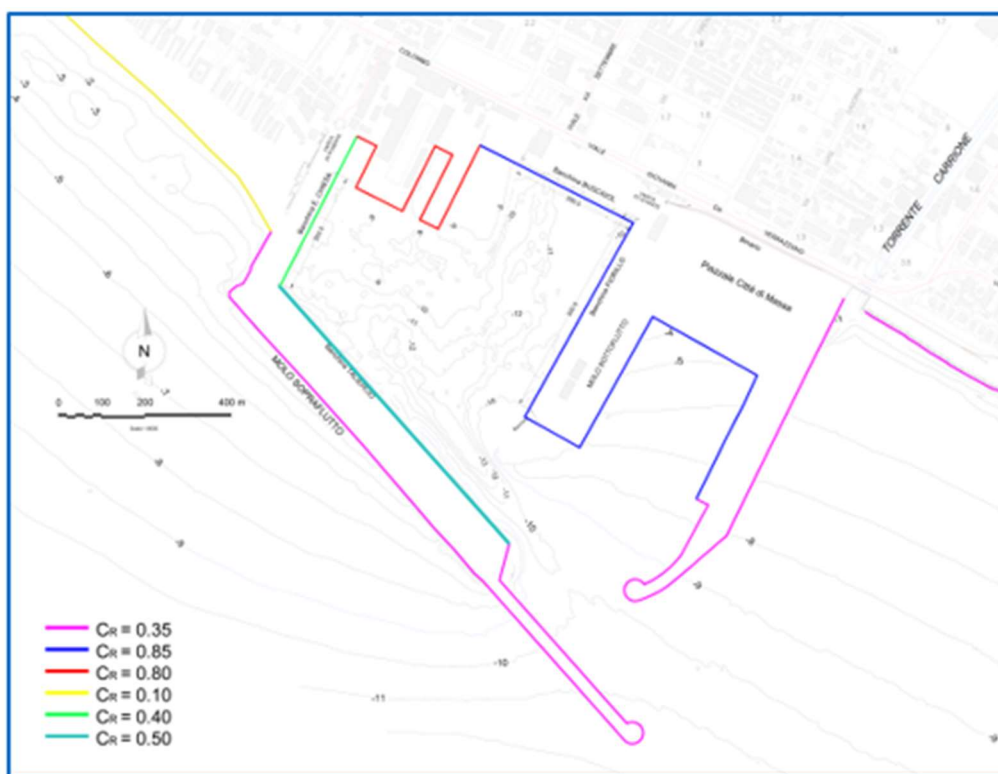
Figura 4-15 - Planimetria della configurazione A2 del Porto di Marina di Carrara con evidenziati i coefficienti di riflessione utilizzati nella modellazione numerica.
