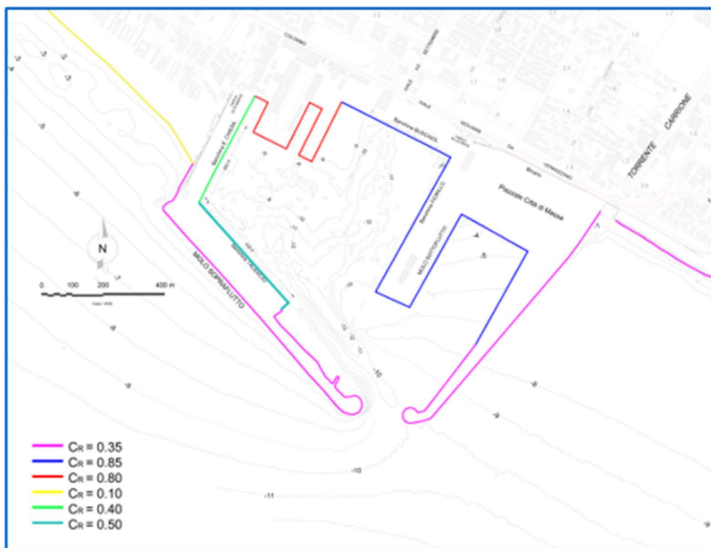
Figura 4-16 - Planimetria della configurazione B1 del Porto di Marina di Carrara con evidenziati i coefficienti di riflessione utilizzati nella modellazione numerica.
