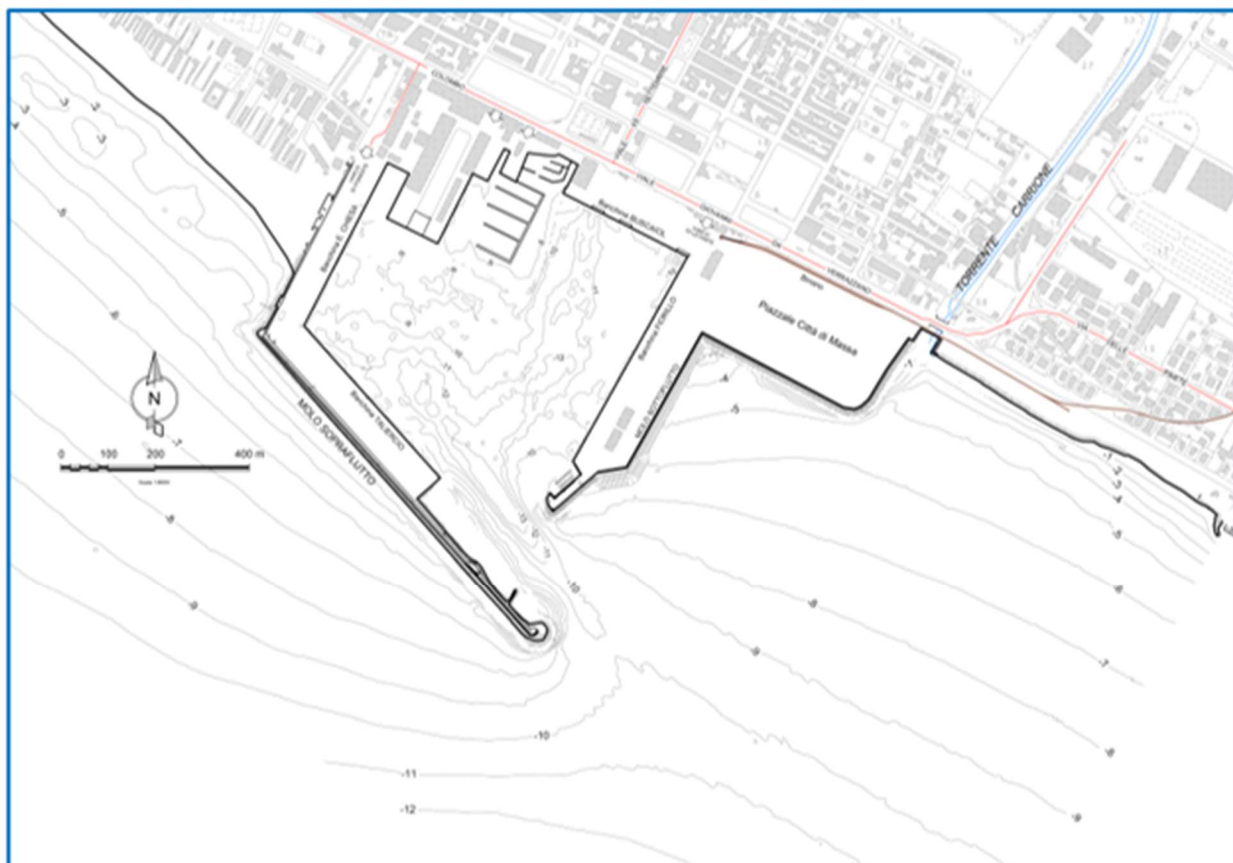
Figura4-1 Schema planimetrico dell'attuale configurazione (a bacino) del porto di Marina di Carrara
