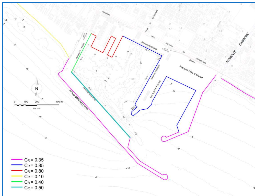
Figura 4-22 – Planimetria della configurazione A3.2 del Porto di Marina di Carrara con evidenziati i coefficienti di riflessione utilizzati nella modellazione numerica.
