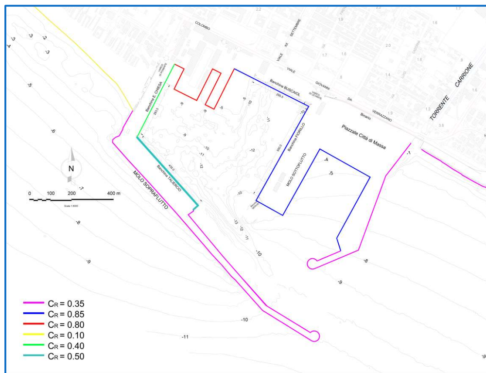
Figura 4-21 - Planimetria della configurazione A3.1 del Porto di Marina di Carrara con evidenziati i coefficienti di riflessione utilizzati nella modellazione numerica.
