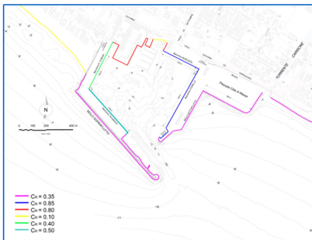
Figura 4-13 – Planimetria della configurazione attuale del Porto di Marina di Carrara con evidenziati i coefficienti di riflessione utilizzati nella modellazione numerica.
