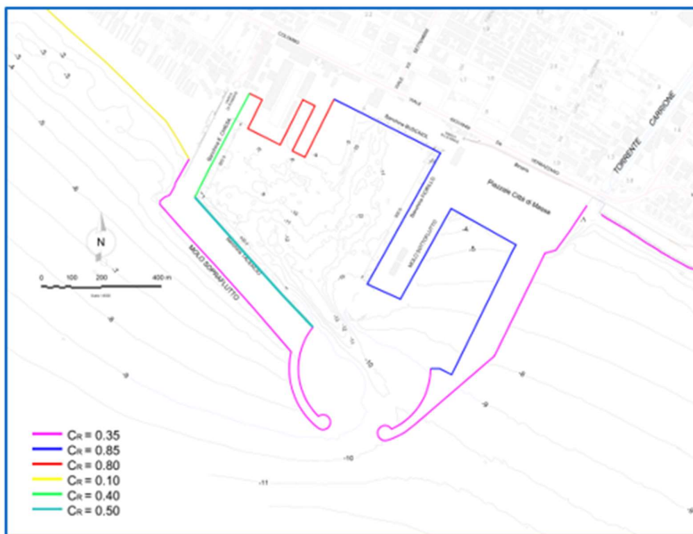
Figura 4-17 - Planimetria della configurazione B2 del Porto di Marina di Carrara con evidenziati i coefficienti di riflessione utilizzati nella modellazione numerica.
