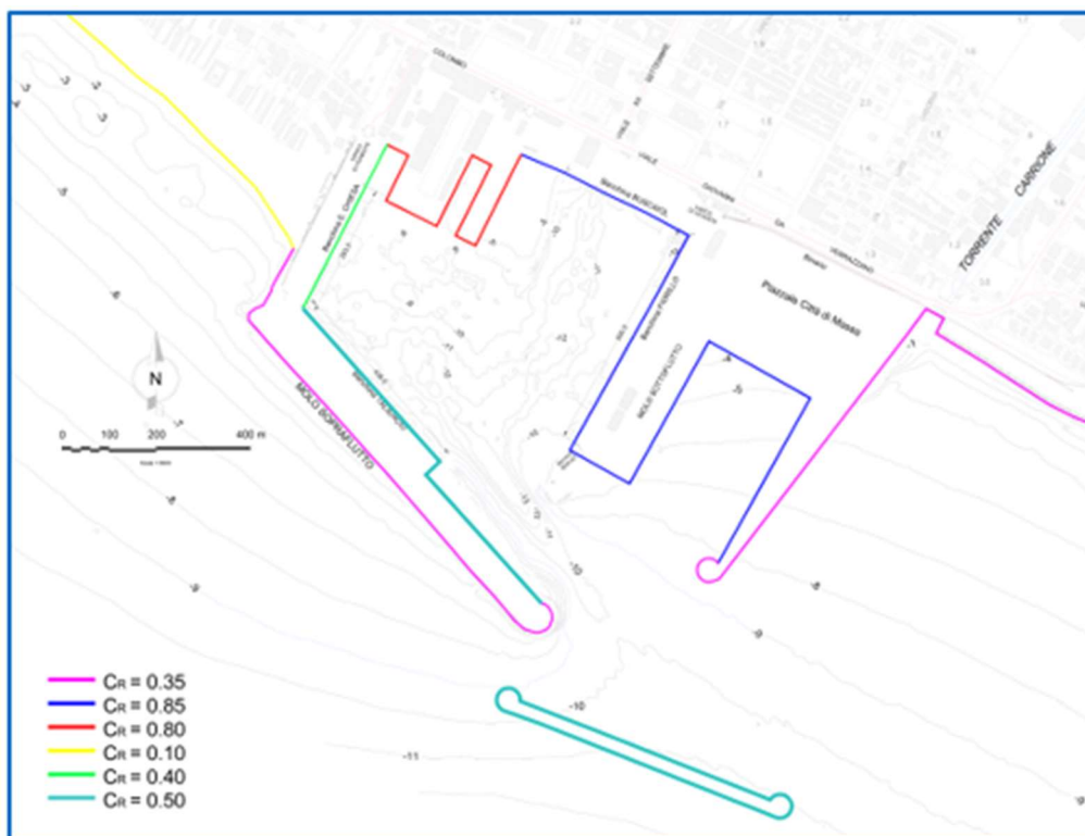
Figura 4-18 - Planimetria della configurazione C1 del Porto di Marina di Carrara con evidenziati i coefficienti di riflessione utilizzati nella modellazione numerica.
