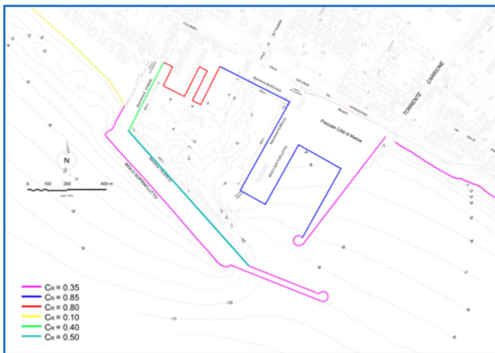
Figura 4-14 - Planimetria della configurazione A1 del Porto di Marina di Carrara con evidenziati i coefficienti di riflessione utilizzati nella modellazione numerica.
