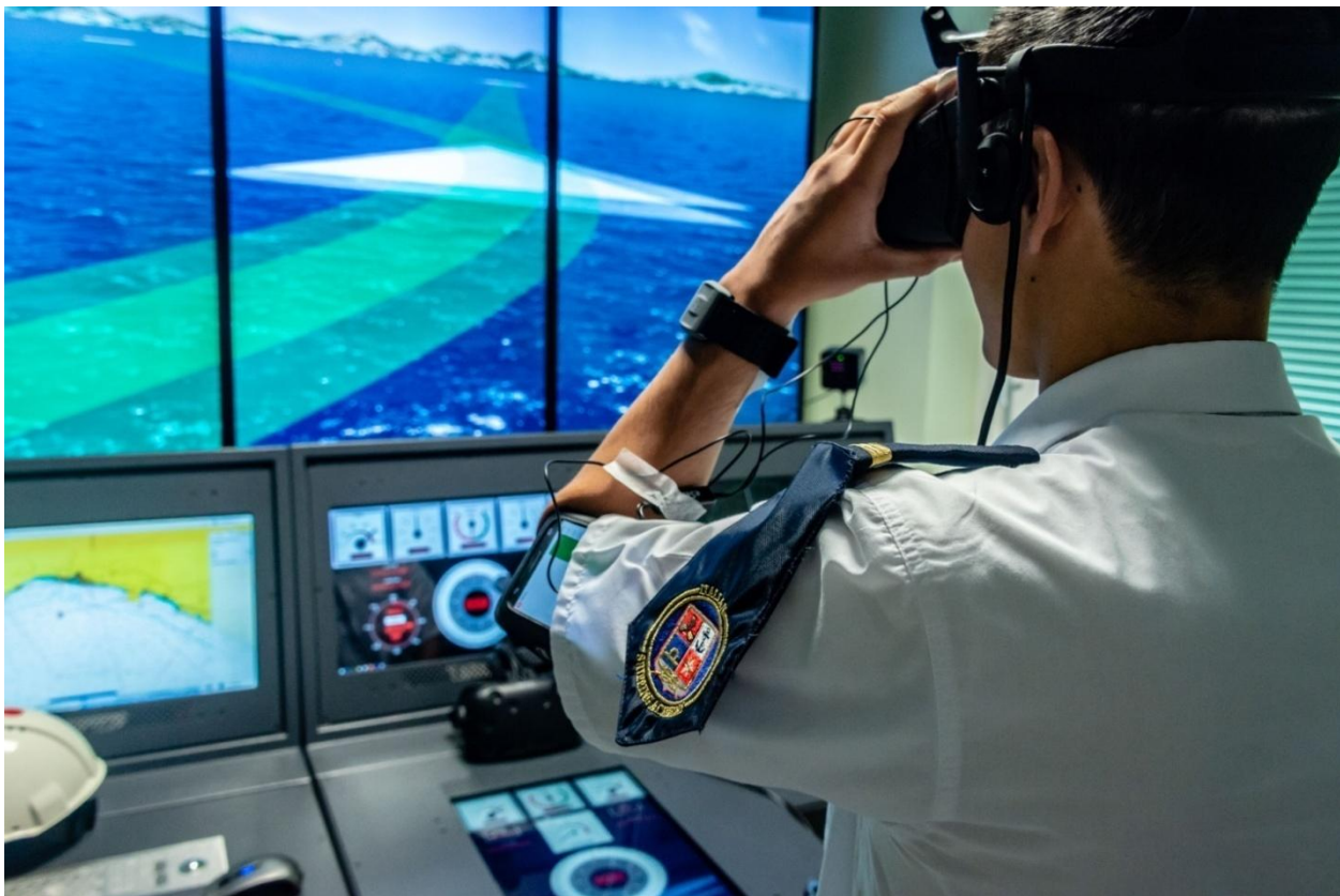
Fig. 8 Simulatore di manovra – Postazione con visore HMD 3D dedicato alla visuale dalle alette
