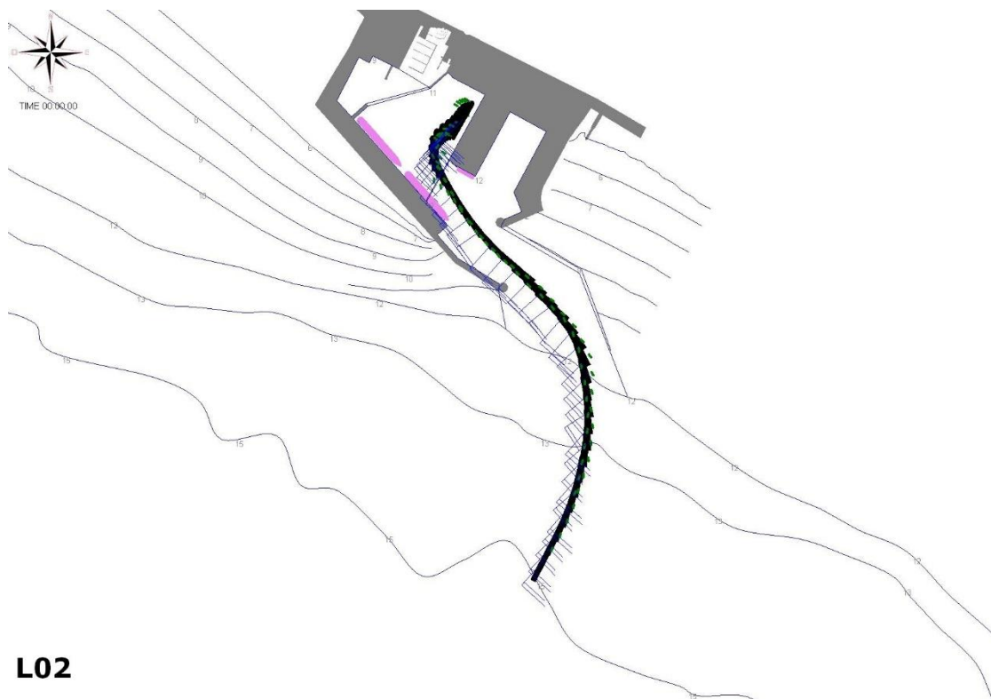
Fig. A - 12 – Manovra L02 – Bulk Carrier 220 - Ingresso - MANOVRA RIUSCITA Vento di Libeccio e onda – Intensità 15 nodi.
