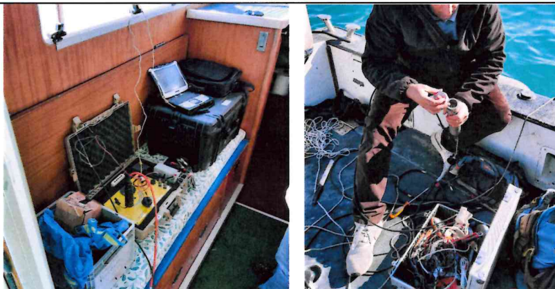
Strumentazione geofisica di acquisizione delle MASW (sismografo a 24 bit DAQlinkIII prodotto dalla Seismic Source Co.-USA) e cannoncino di energizzazione al fondale
