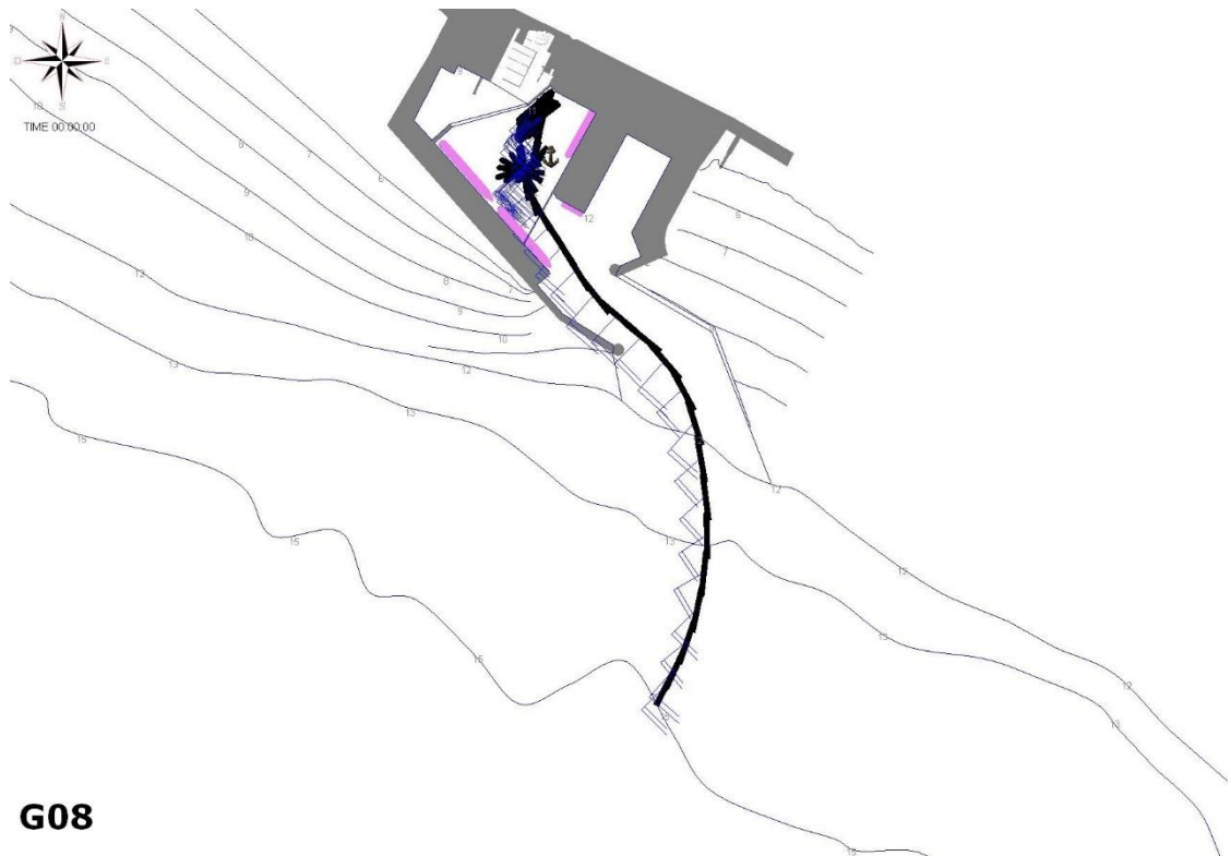
Fig. A - 34 – Manovra G08 – Ro-Ro 200 - Ingresso - MANOVRA RIUSCITA Vento di Libeccio e onda – Intensità 15 nodi.
