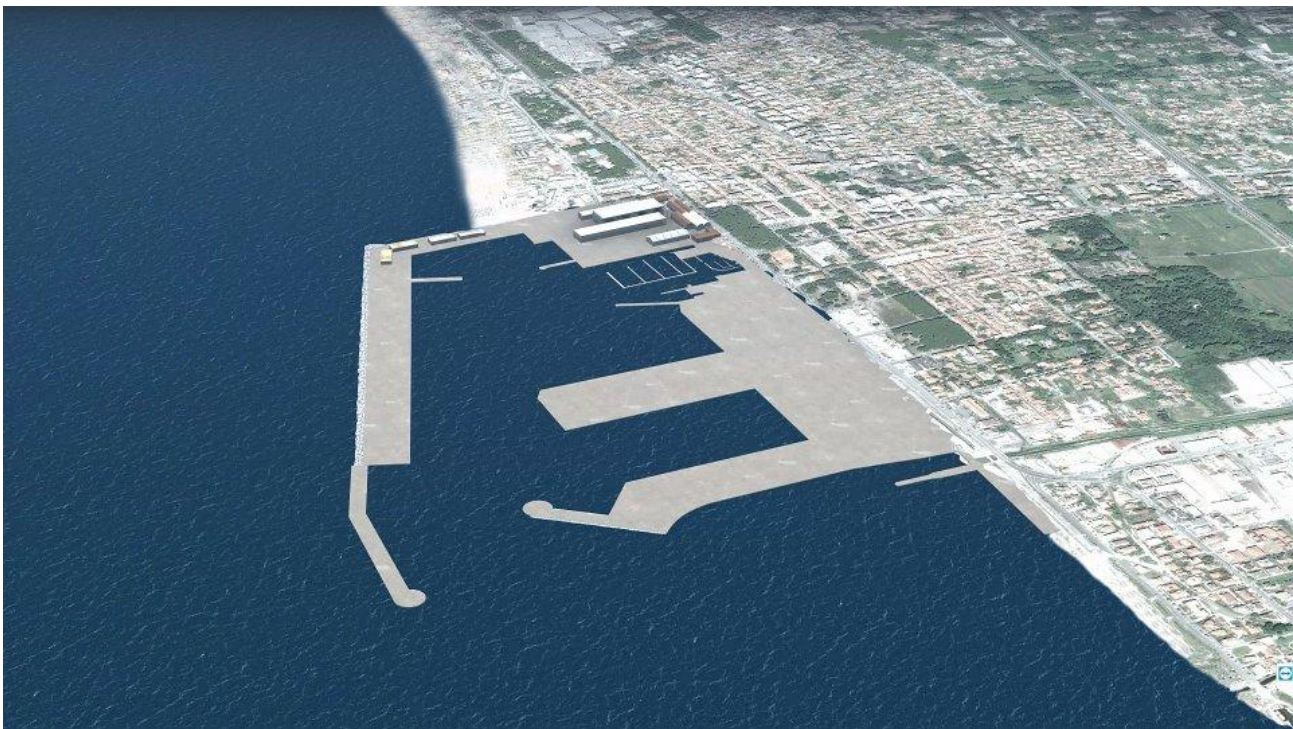
Fig. C - 8 – Vista 3D del layout di proposta di PRP utilizzato durante le simulazioni di manovra
