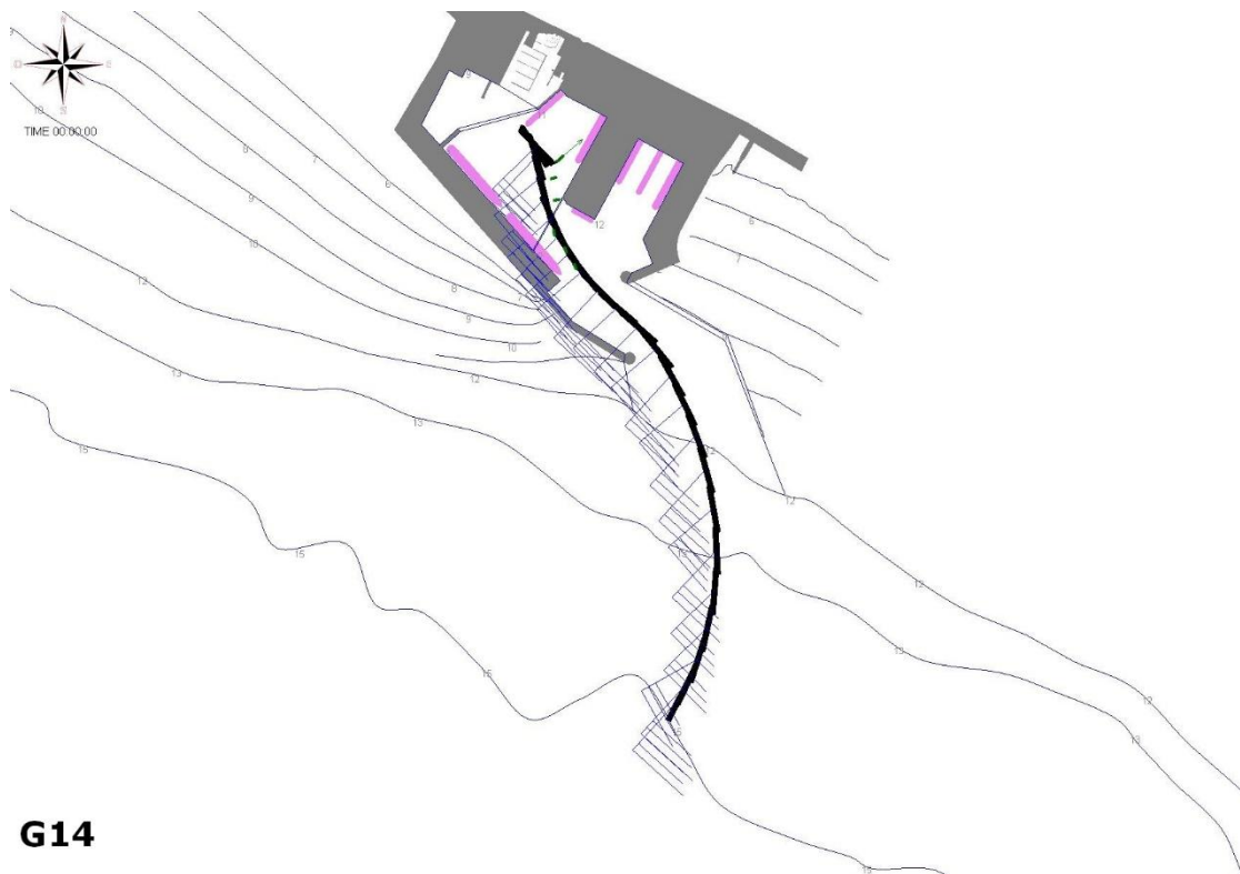
Fig. A - 40 – Manovra G14 – Ro-Ro 200 - Ingresso - MANOVRA NON RIUSCITA Vento di Libeccio e onda – Intensità 25 nodi.
