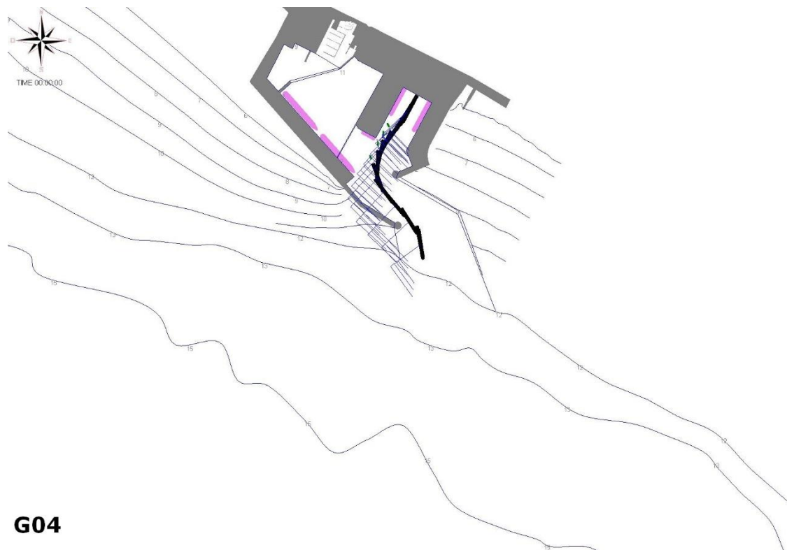
Fig. A - 30 – Manovra G04 – Ro-Ro 200 – Uscita - MANOVRA RIUSCITA Vento di Libeccio e onda – Intensità 25 nodi.
