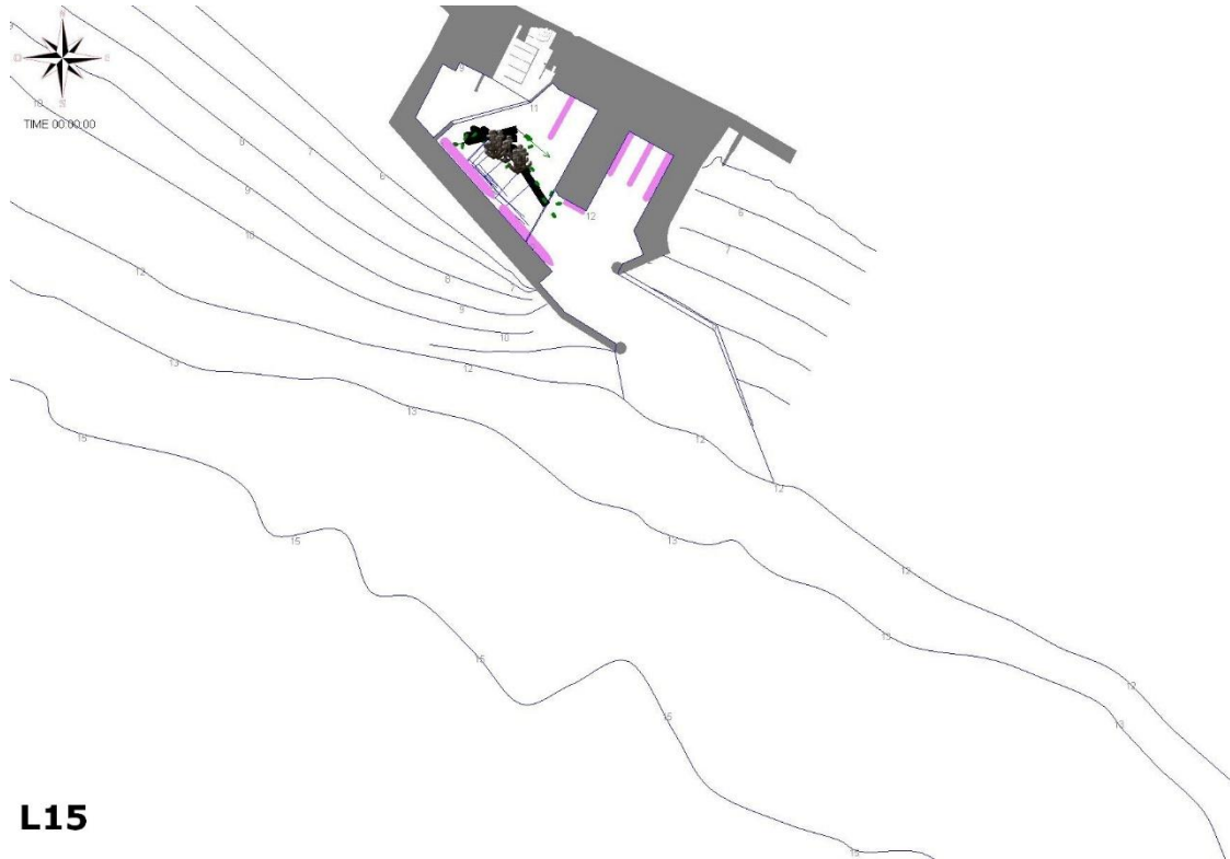
Fig. A - 25 – Manovra Avaria L15 – Bulk Carrier 220 - Ingresso - MANOVRA RIUSCITA
