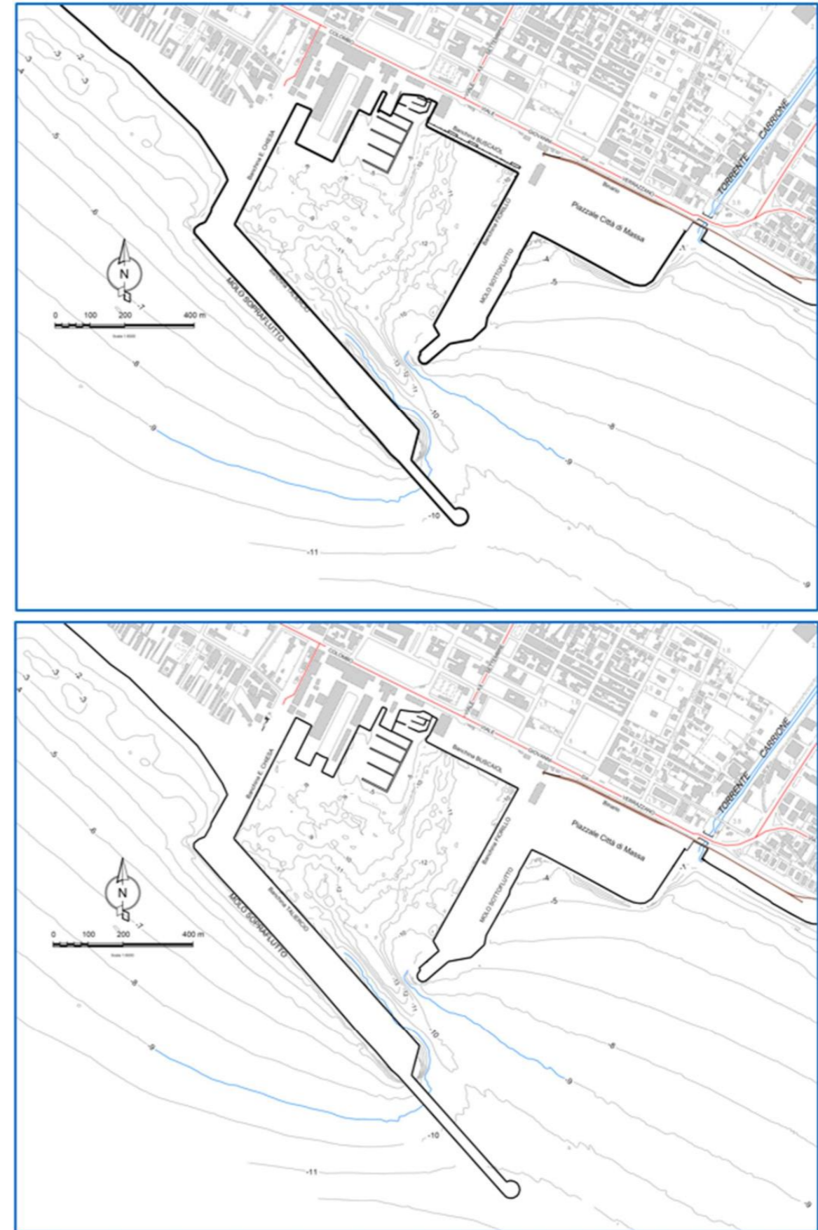
Figura 6.1: Layout AA1 (sopra) e AA2 (sotto) con solo prolungamento del molo di soprafflutto
