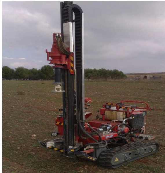
FIGURA 36 - MACCHINA BATTIPALO PER INFIESSIONE PALI.
