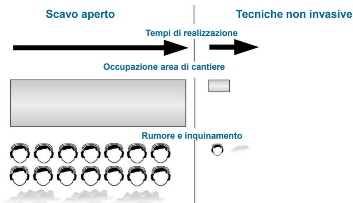
Figura 2 - confronto tra scavo aperto e tecniche non invasive
