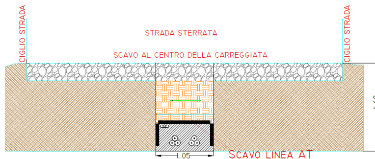
Scavi cavidotti AT
