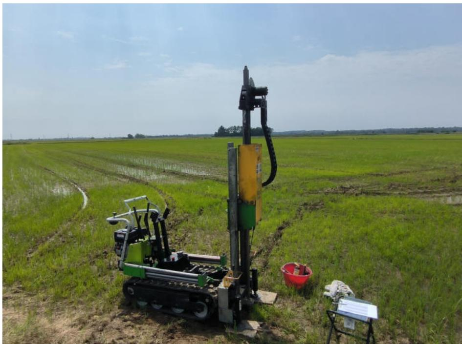
**Fig.1 - Prova Penetrometrica Dinamica DPSH 1**
