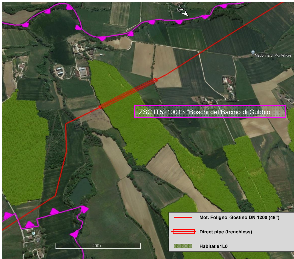
Fig. 2/B: Particolare attraversamento dell'area boscata (habitat 91L0) con Direct pipe
