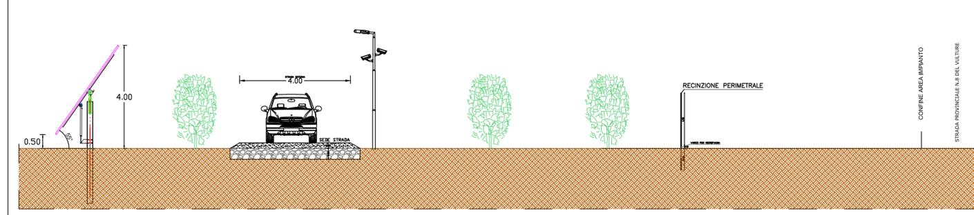
PARTICOLARE RECINZIONE CON OPERE DI MITIGAZIONE DELL'IMPIANTO FOTOVOLTAICO
