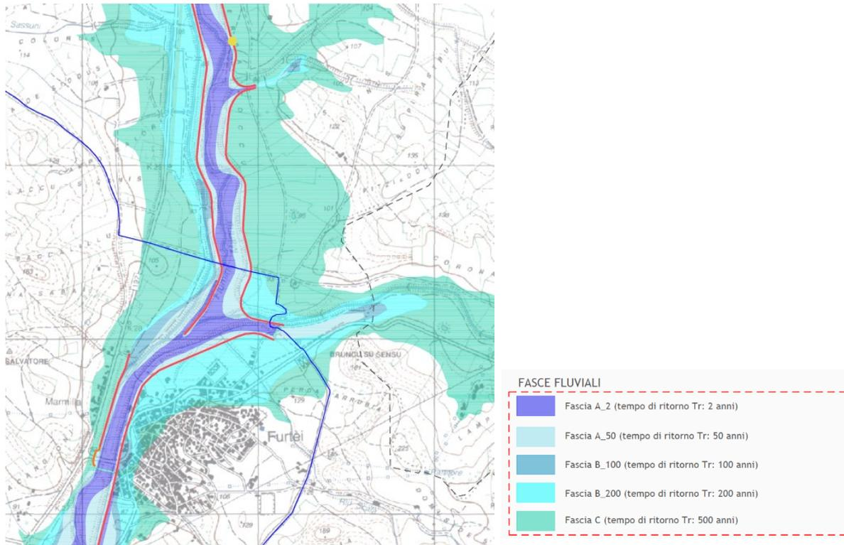
Figura 15 – Dettaglio 1) Cavidotto max 36 kV, Piano Stralcio delle Fasce Fluviali
