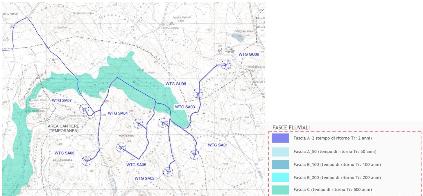
Figura 16 – Dettaglio 2) Cavidotto max 36 kV, Piano Stralcio delle Fasce Fluviali
