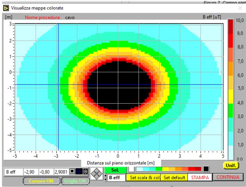
Figura 4. Campo elettromagnetico generato dal cavo interrato.
