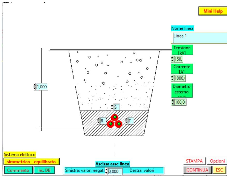
Figura 3. Configurazione geometrica impiegata per il calcolo delle DPA prodotte dal cavo interrato
