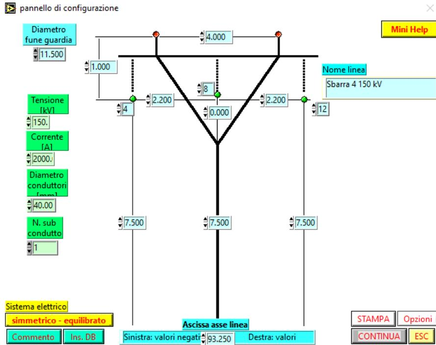
Figura 2. Configurazione geometrica impiegata per il calcolo delle DPA prodotte dalla sbarra e dagli stali utente
