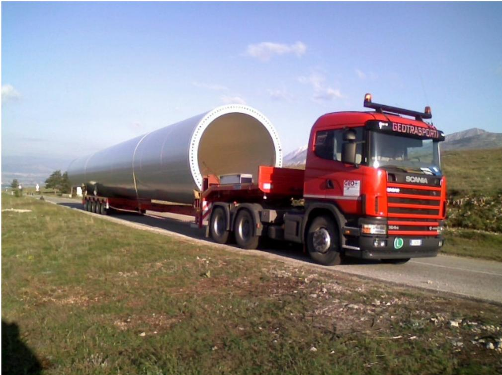
Figura 2 | Trasporto componenti – torre eolica
