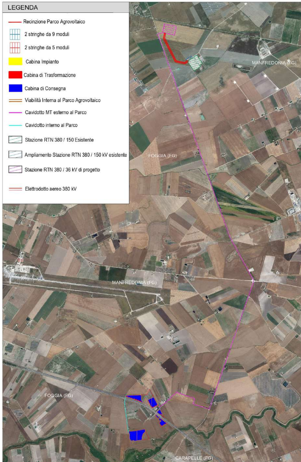
Figura 5-4 – Impianto agrivoltaiico e connessione alla stazione 36/150/380 kV
