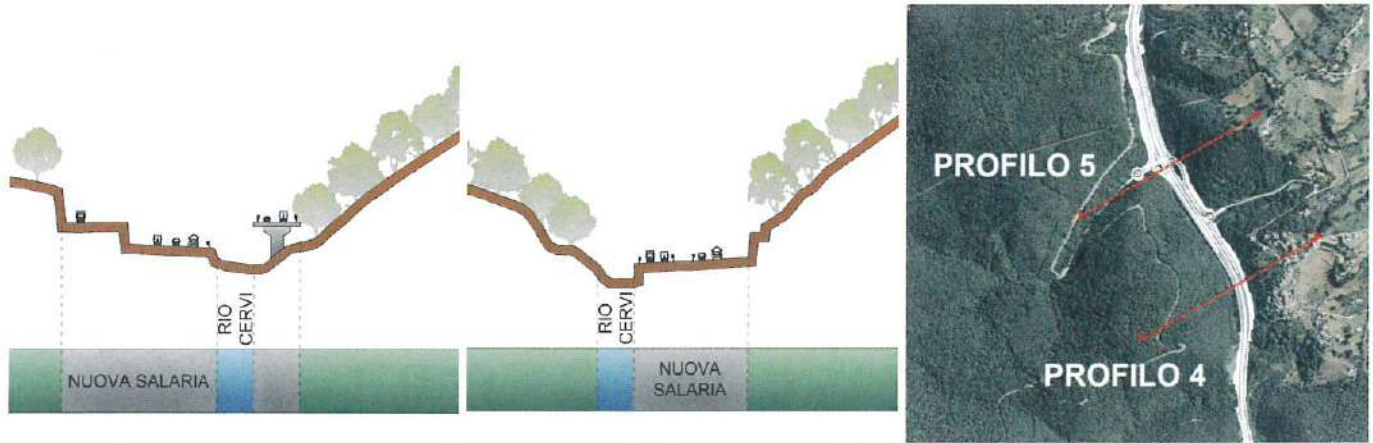
Fig. 22b Sezioni paesaggistiche - Lotto 1. Dettagli dei Profili 4 e 5 in prossimità dello Svincolo di Ornaro Alto, post-operam in cui si nota la trasformazione apportata dall'infrastruttura nei confronti del "Rio Cervi" (cfr. T02IA02AMBCT13A )
