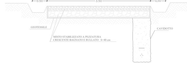
SEZIONE TIPO CAVIDOTTO
