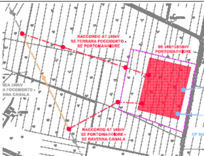
Raccordi con la linea 380 Kv
