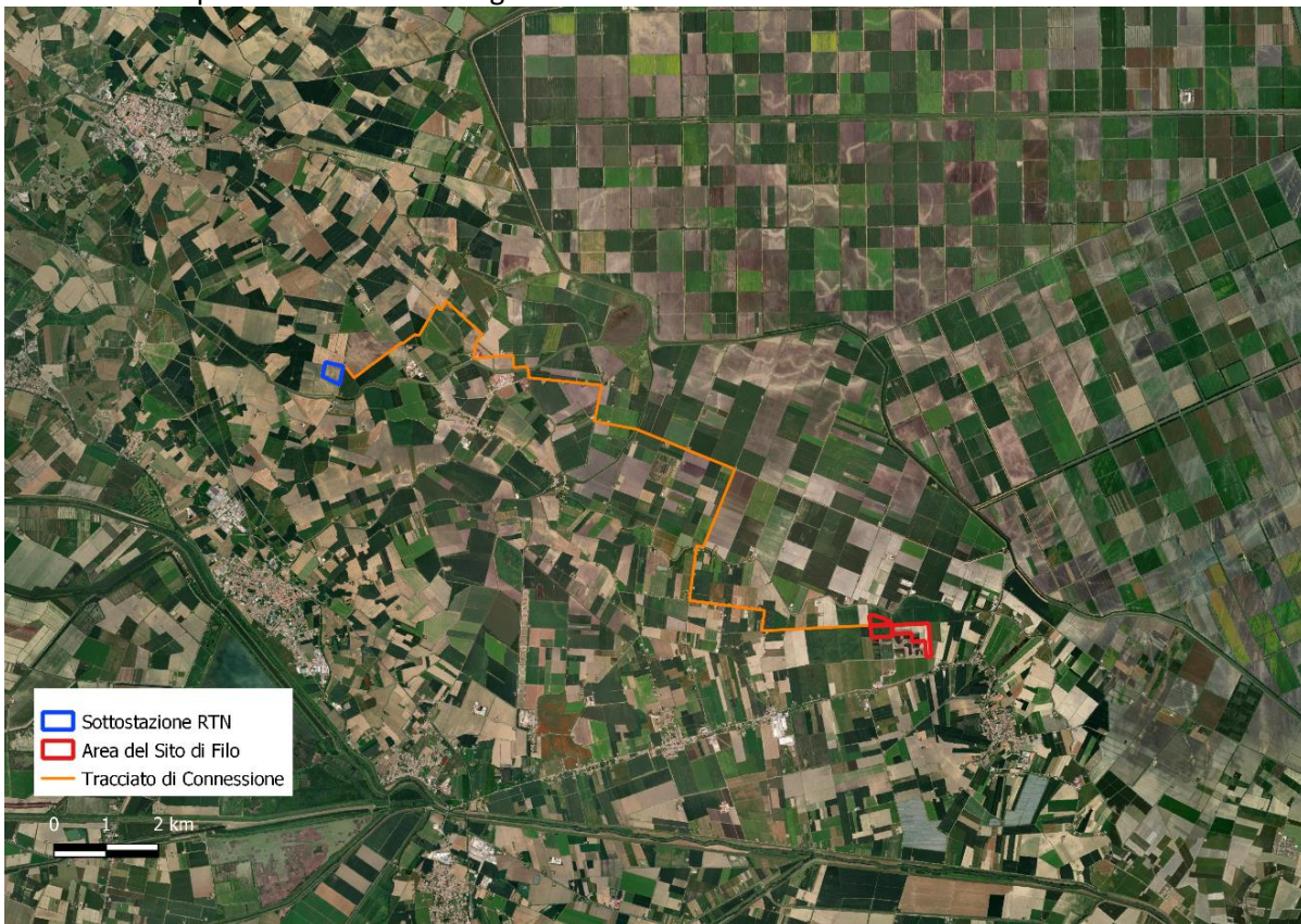
Figura 4- Inquadramento del tracciato del cavidotto
