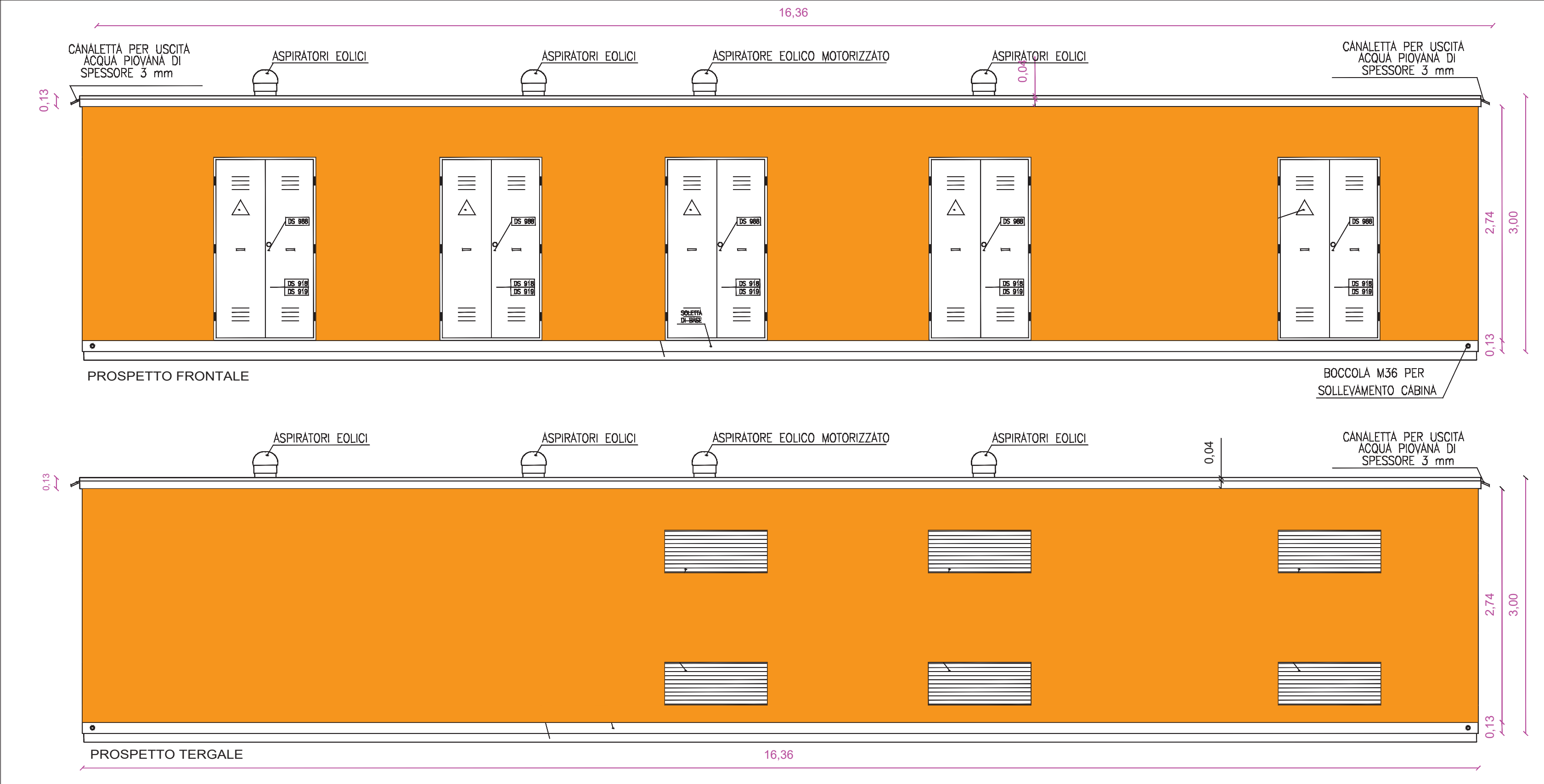
PROSPETTI FRONTALE E TERGALE CABINA DI INTERFACCIA
