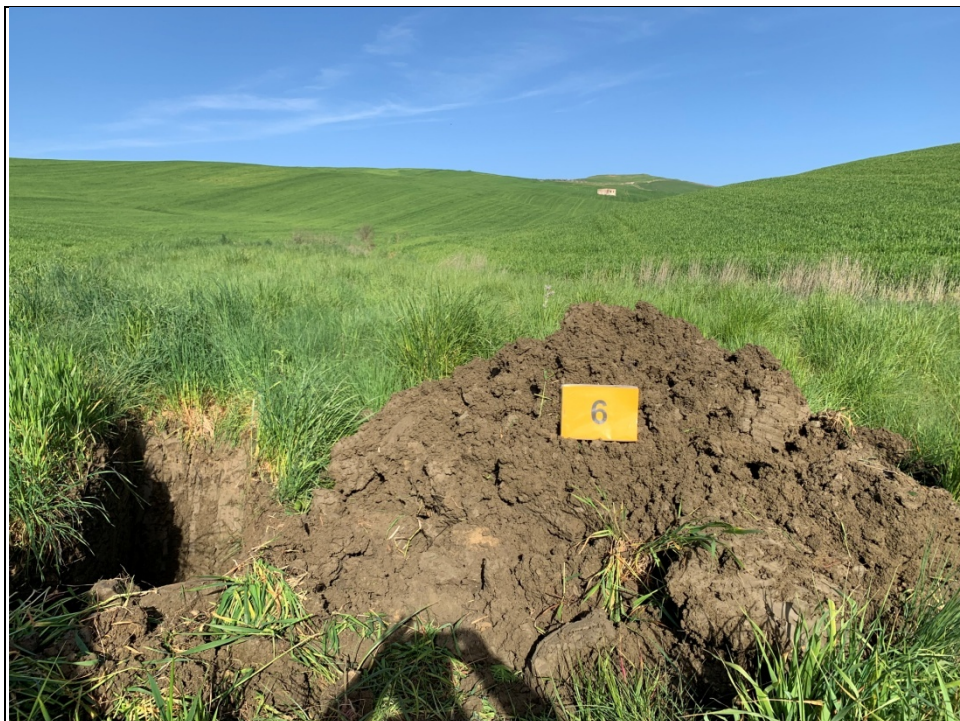
Scavo a pozzo in corrispondenza della Torre 6
