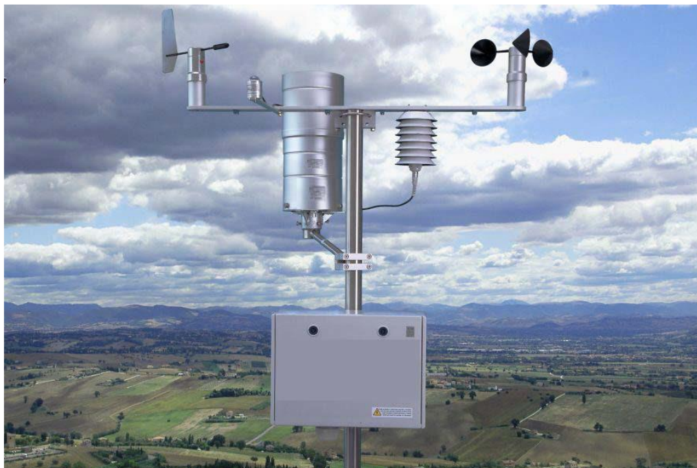
Figura 5 - Esempio di stazione meteorologica multi-parametrica
