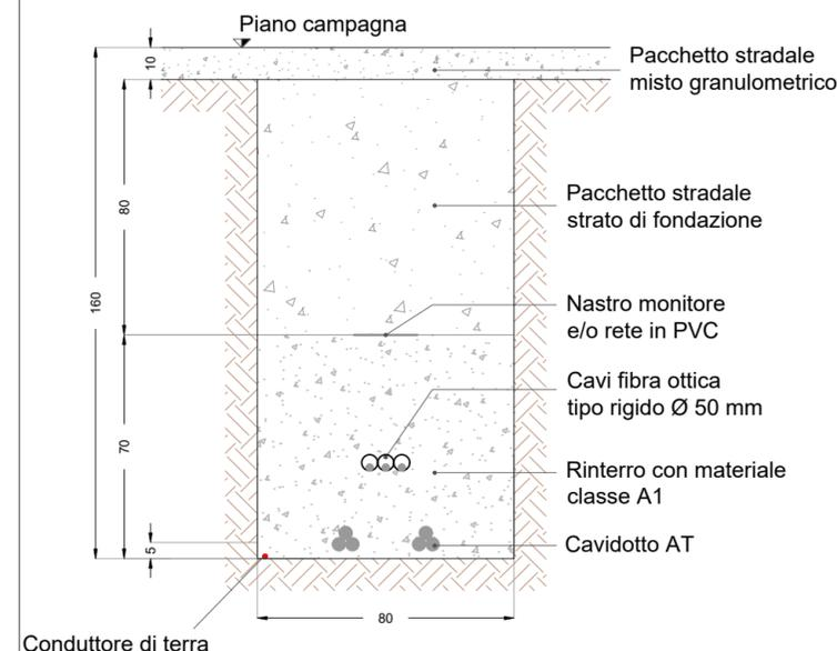
**SEZIONE TIPO CAVIDOTTO 150 KV
