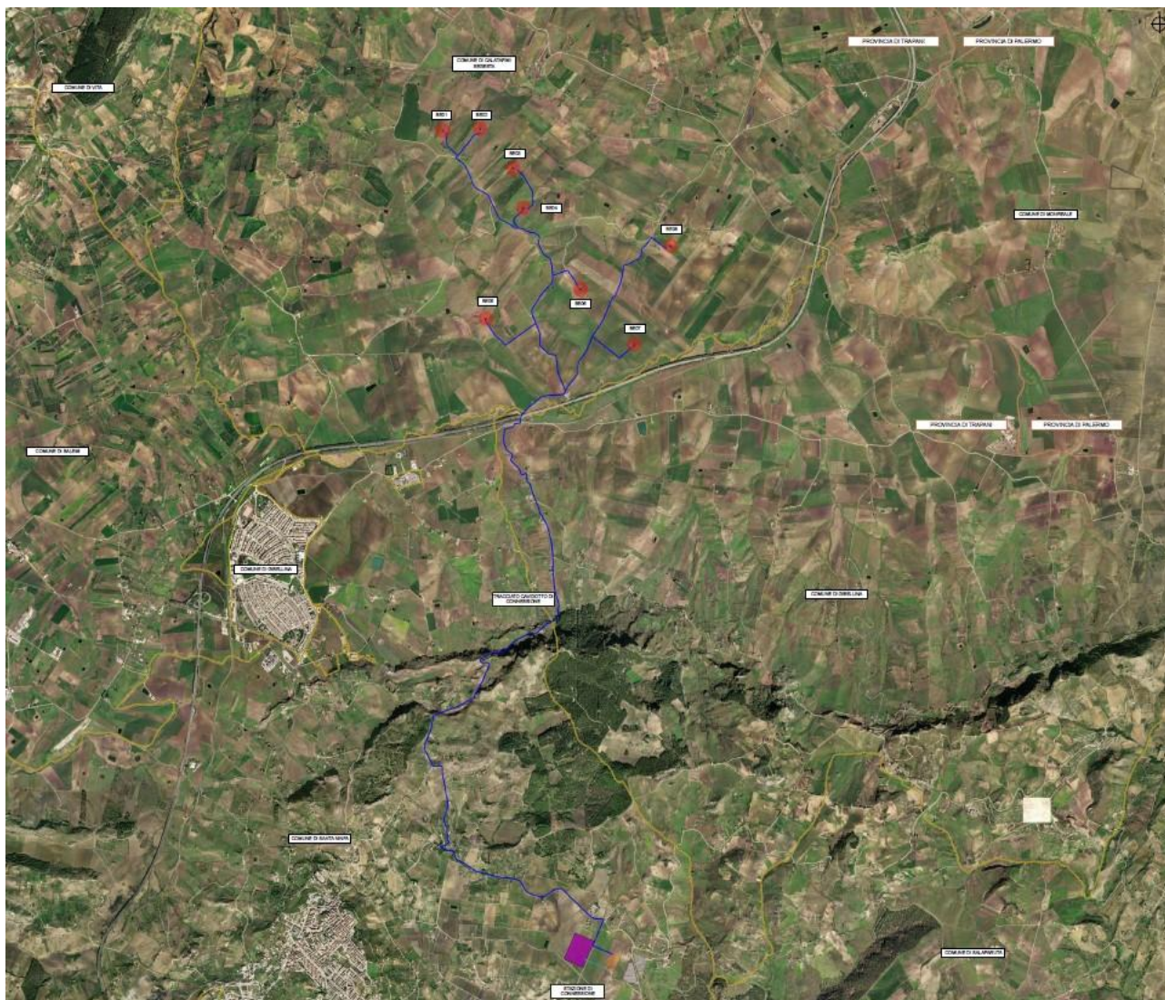
Figura 1 Inquadramento del progetto su ortofoto; in rosso gli aerogeneratori con la loro "ombra eolica", in violetto la stazione di connessione alla RTN ed in arancio, accanto, l'area della SSE utente di trasformazione
