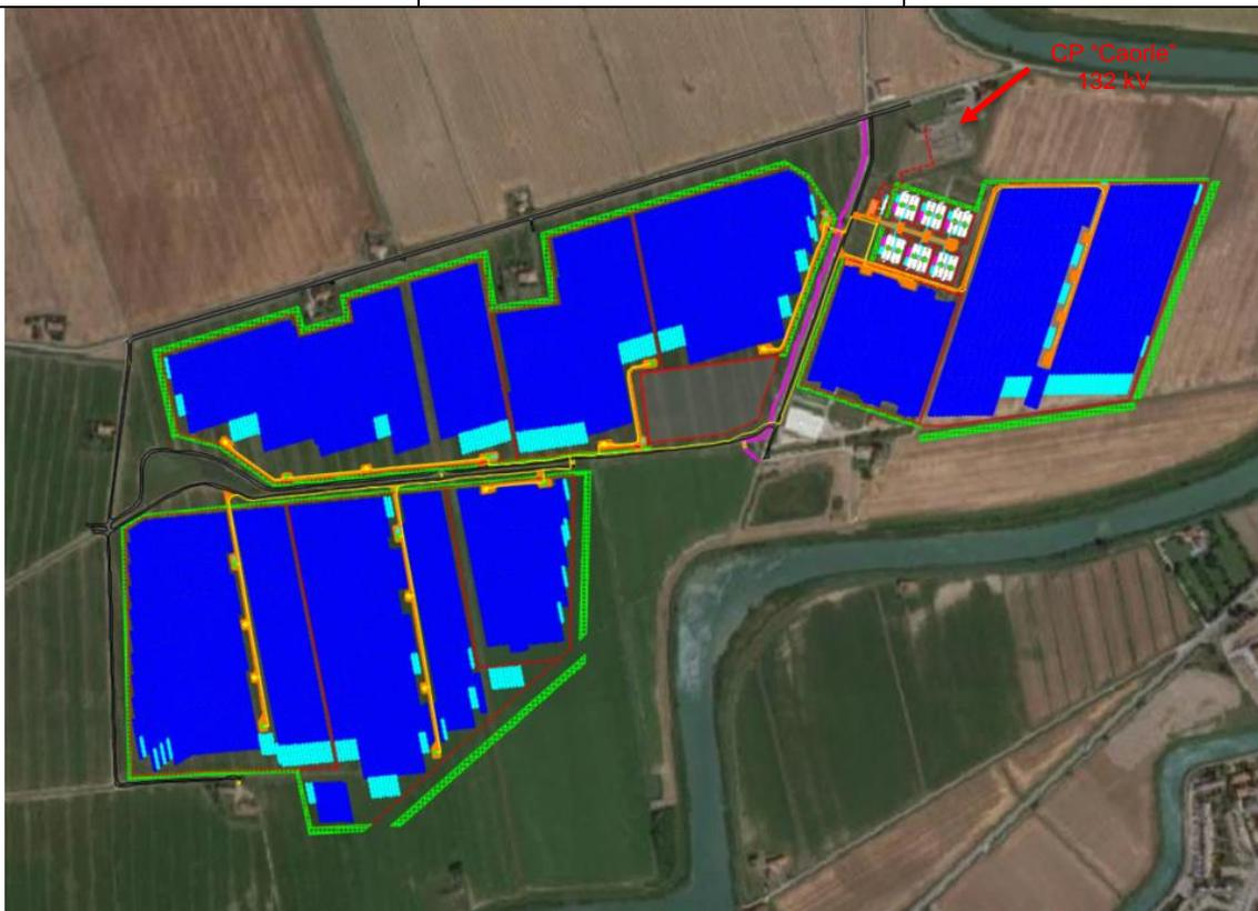
**Figura 2 – Sovrapposizione su ortofoto del layout di impianto con indicazione del collegamento alla Cabina Primaria “Caorle”**
