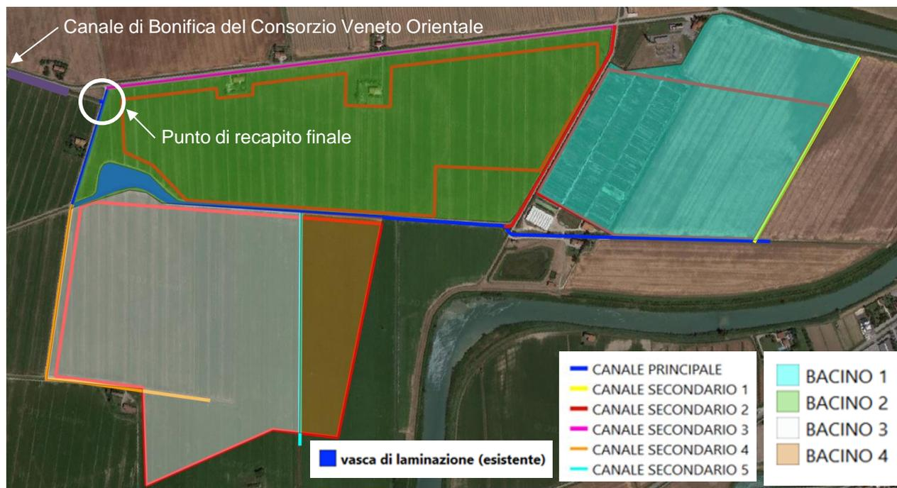
**Figura 9 – Schematizzazione dei bacini di drenaggio, dei canali secondari e del canale principale.**
