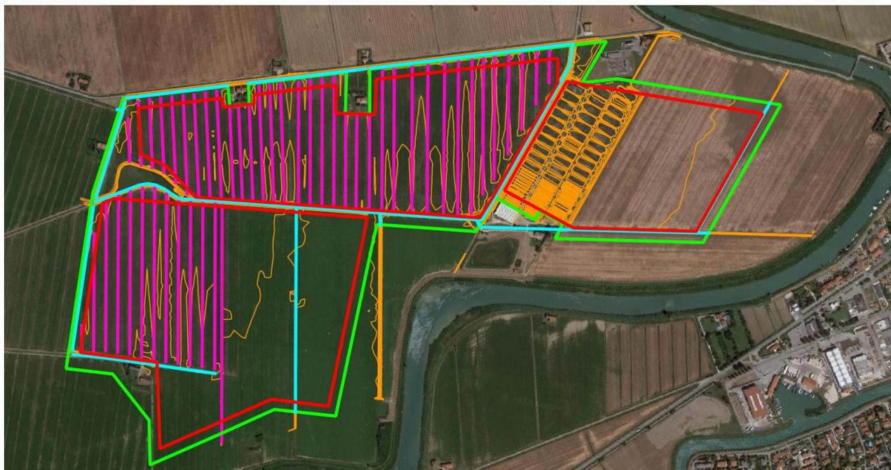
Figura 5 – Inquadramento dell'area in esame (in rosso) su rilievo topografico con passo 50 cm (in arancione), canali di scolo esistenti (in Ciano), fossi per irrigazione (in magenta) e area contrattualizzata ( in verde) su ortofoto
