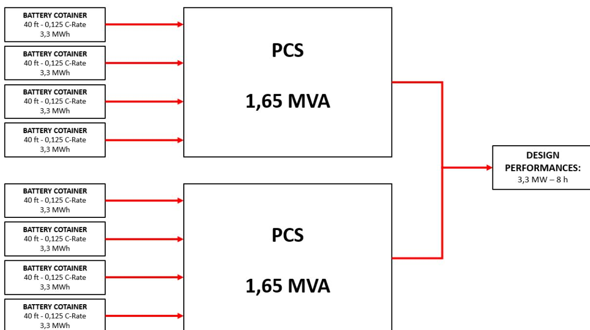
Il BESS di ogni impianto sarà dotato di n.2 PCS, per un valore di potenza per singolo impianto di 3,3 MW.
