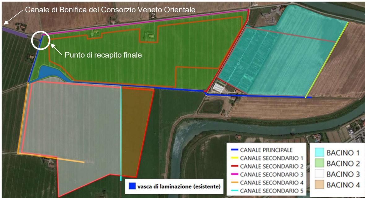
**Figura 7 – Schematizzazione dei bacini di drenaggio, dei canali secondari e del canale principale.**
