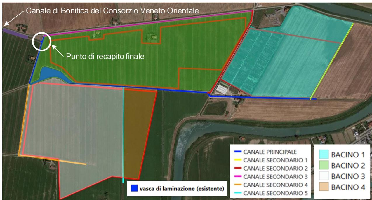
Figura 25 – Schematizzazione dei bacini di drenaggio, dei canali secondari e del canale principale.
