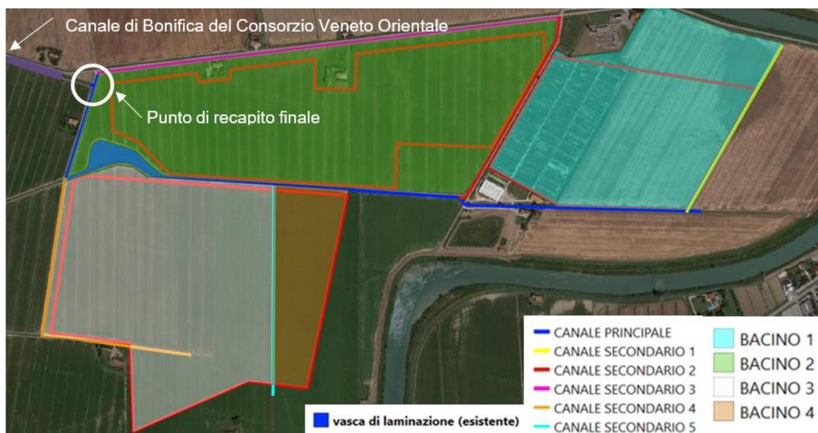
Figura 5 - Schematizzazione dei bacini di drenaggio, dei canali secondari e del canale principale.
