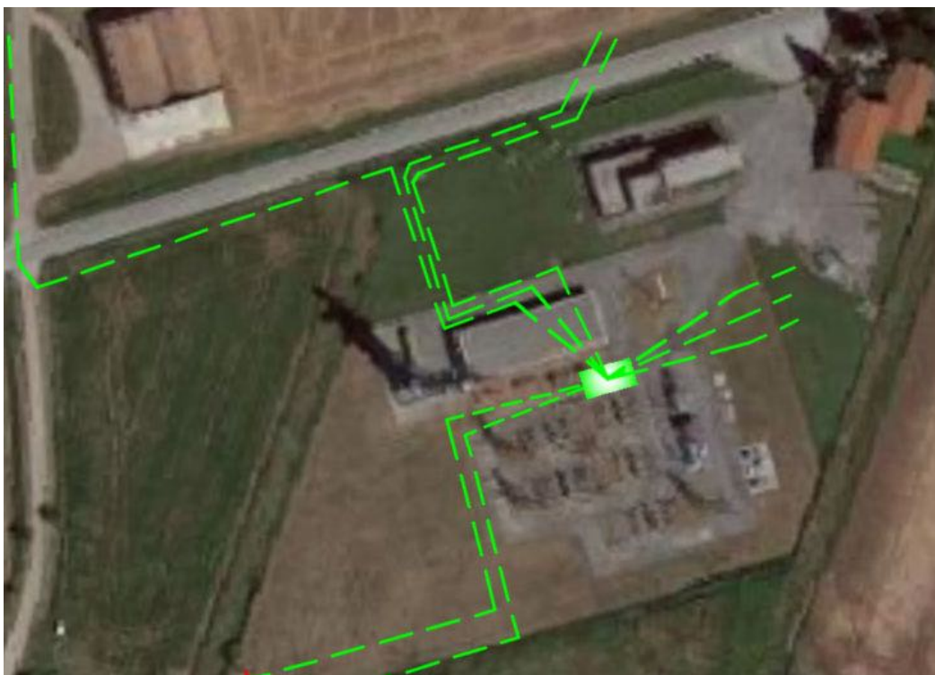
Figura 5 - Sovrapposizione della posizione della Cabina ED e delle linee esistenti riportate nella STMG su ortofoto - evidenza disallineamento tra l'effettiva posizione della cabina ED e quanto riportato in STMG
