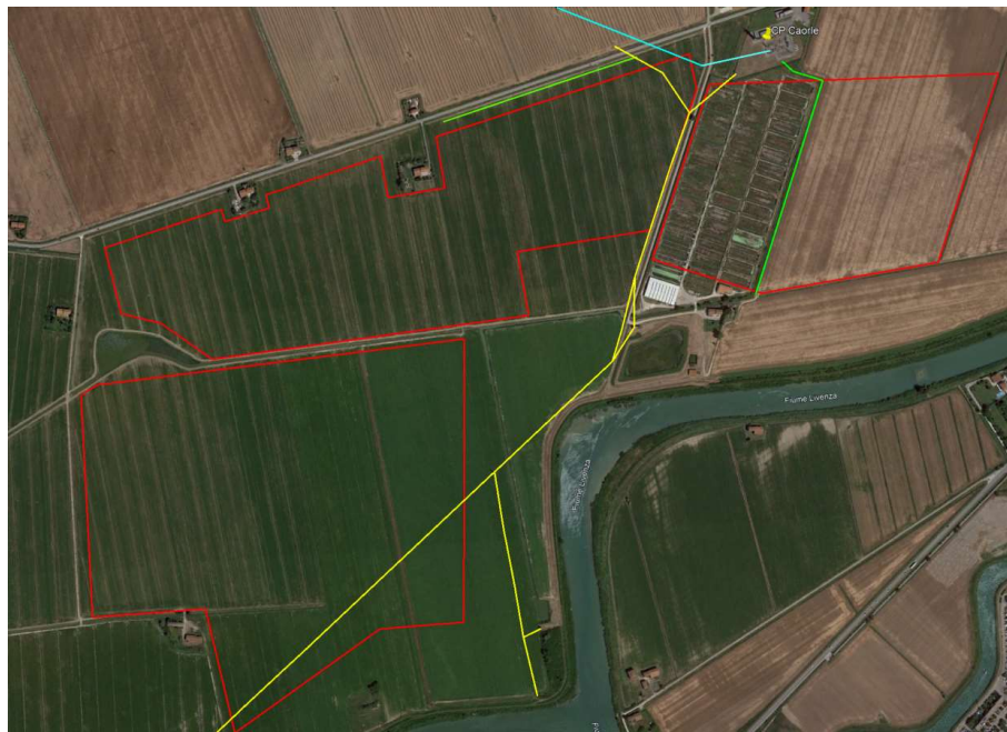
Figura 62 – Inquadramento satellitare dell'area di impianto (in rosso), della linea elettrica AT (in ciano), delle linee elettriche MT (in giallo), della linea elettrica BT (in verde).
