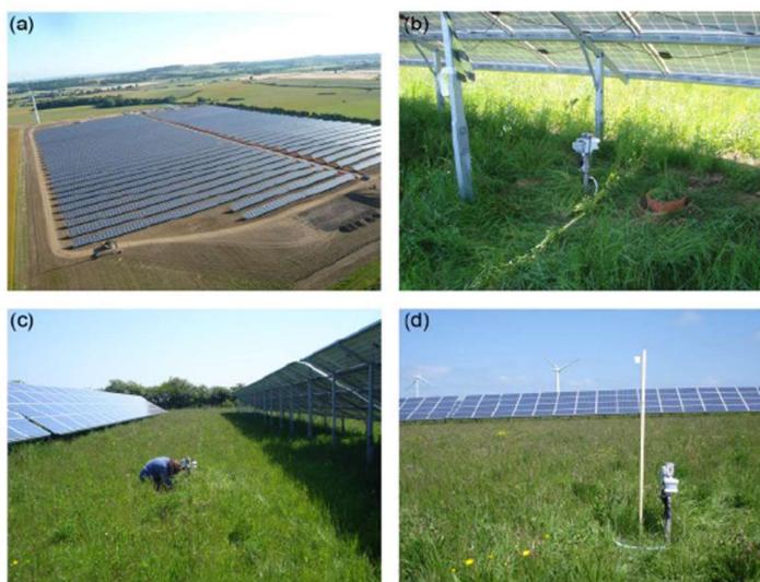
Figura 109 – (a) foto aerea del Westmill Solar Park; (b) Under: punto di rilevamento sotto i moduli; (c); Gap: punto di rilevamento tra i filari di moduli; (d) Control: punto di rilevamento esterno
