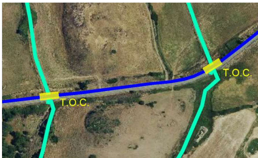
Figura 29: Inquadramento su ortofoto di interferenza I02 e I02 - Attraversamenti trasversali di reticolo idrografico mediante T.O.C..
