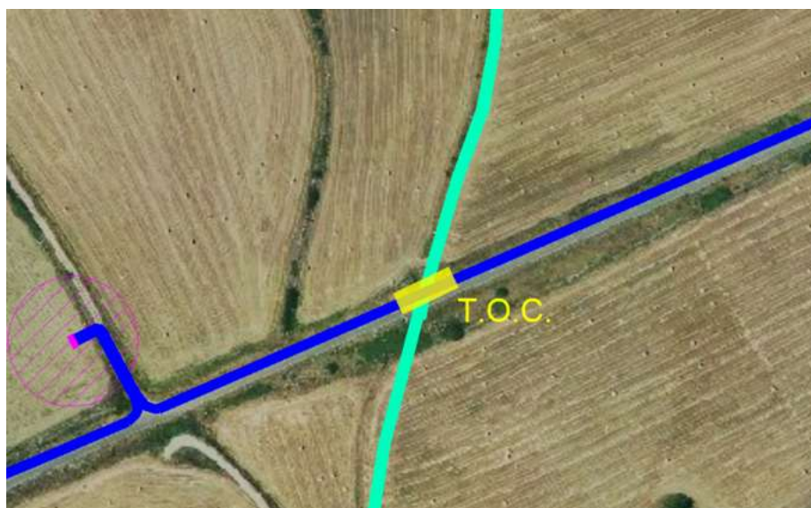
Figura 30: Inquadramento su ortofoto di interferenza I04 - Attraversamento trasversale di reticolo idrografico mediante T.O.C..
