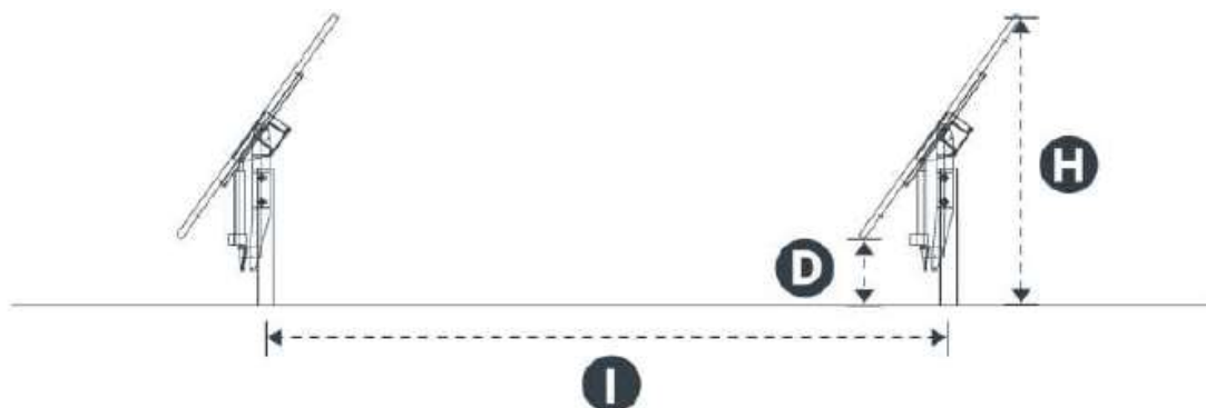
Figura 3: – Distanza strutture portamoduli.
