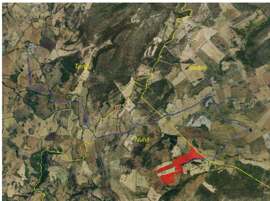
Figura 4 - Inquadramento del percorso del cavidotto su ortofoto
