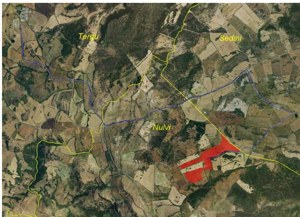
Figura 4 - Inquadramento del percorso del cavidotto su ortofoto
