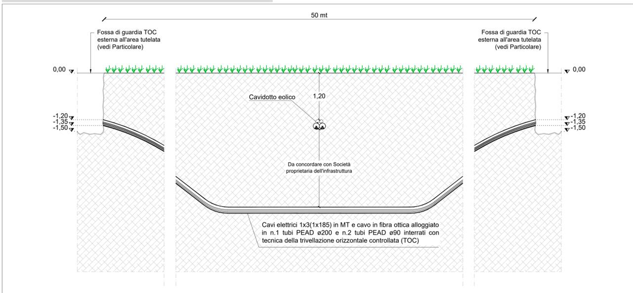
Particolare scavo in TOC su terreno agricolo - Scala 1:10
