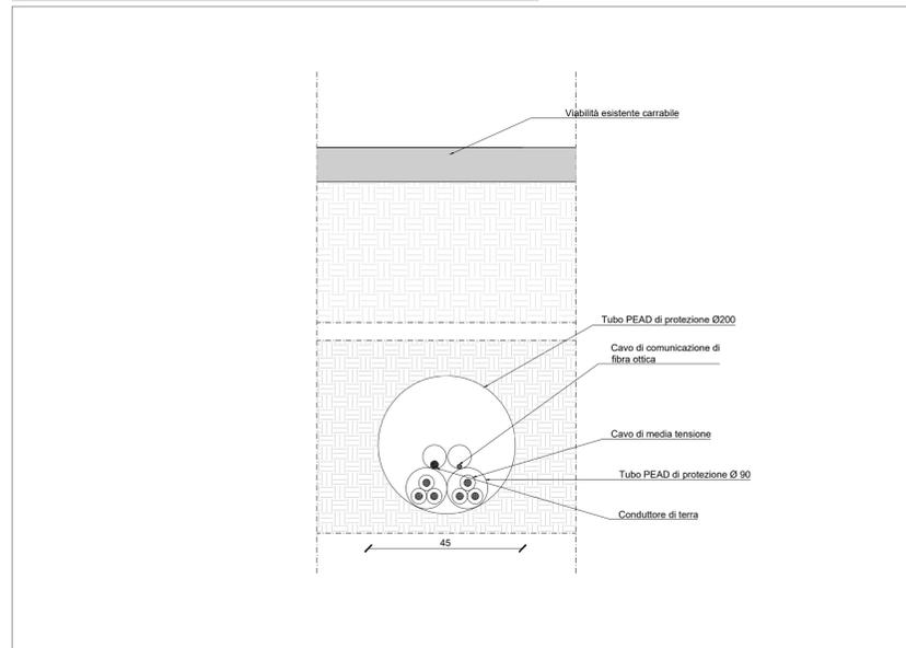
Intersezione con cavidotto cavi eolico - Sezione
