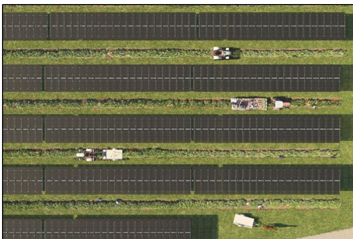
DETTAGLIO PLANIMETRICO DELLE AREE LASCIATE LIBERE ALLA COLTIVAZIONE A FORAGGIO SIA TRA I FILARI CHE SOTTO AI PANNELLI.
