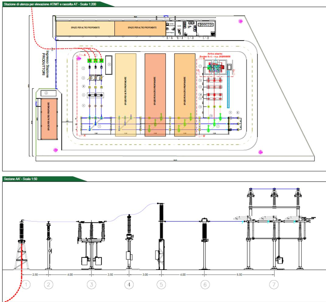
Figura 1. 3 Pianta e sezioni del sistema di sbarre di raccolta AT
