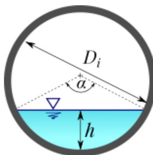
Figura 5. 3 Sezione condotta a pelo libero
