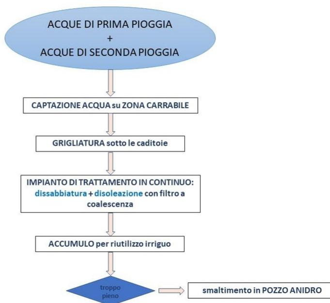
**Figura 5. 1 Diagramma di flusso trattamento acque meteoriche**
