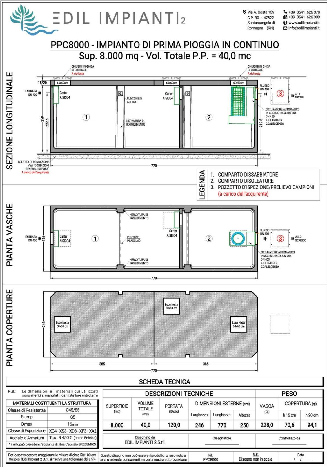
Figura 5. 7 Vasche di sedimentazione e disoleazione
