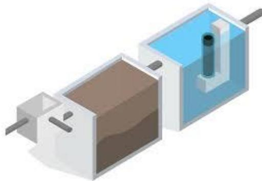
**Figura 5. 4: schema dissabbiatore + disoleatore in continuo**
