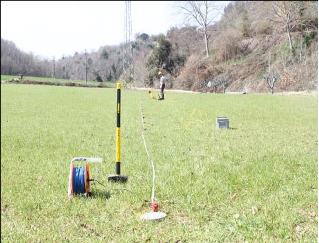
Figura 2.8 - Operazioni di acquisizione del segnale sismico.
