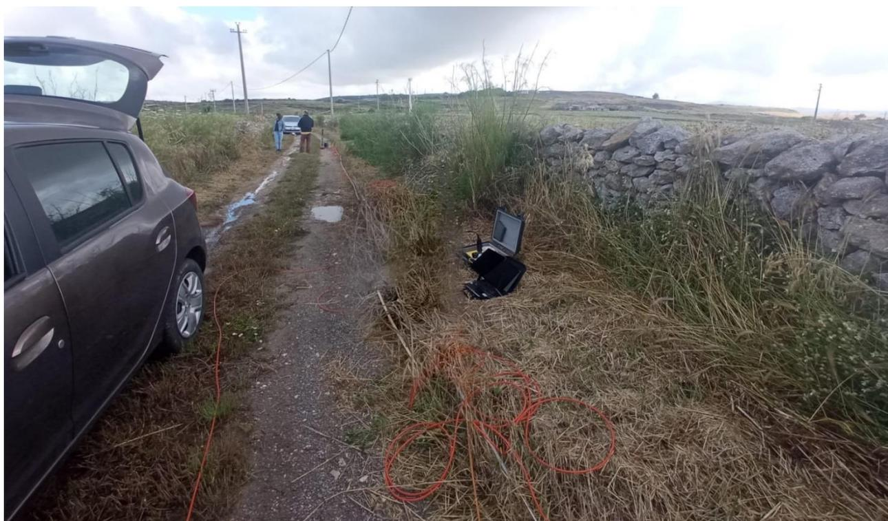
Figura 2.2 – Disposizione dello stendimento MASW1.
