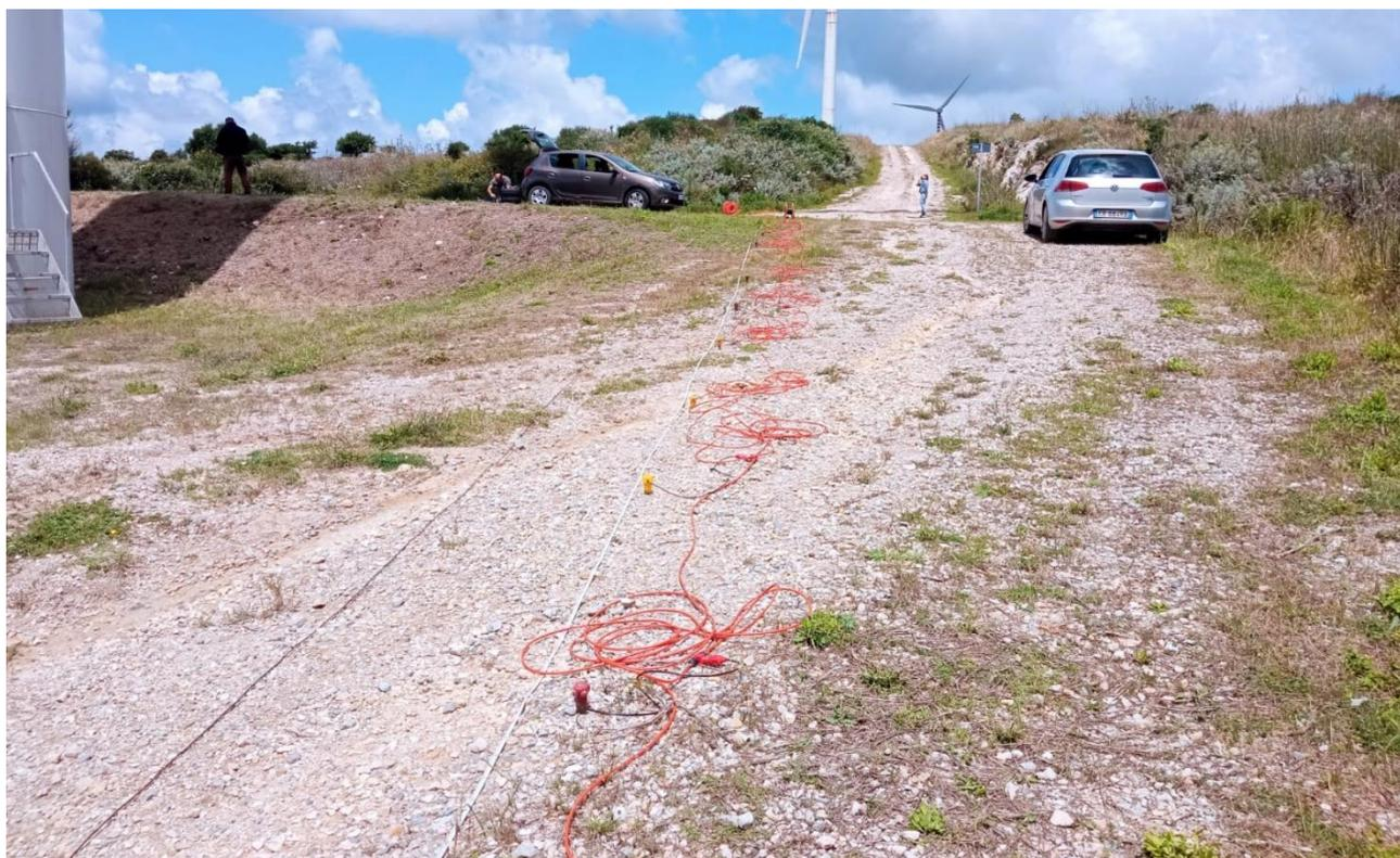
Figura 2.5 - Disposizione dello stendimento MASW1.
