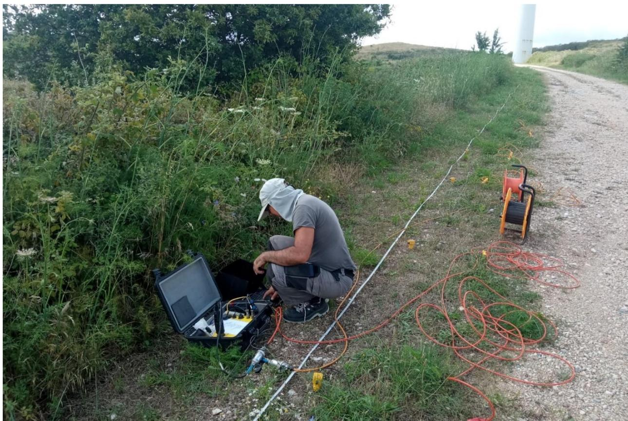
Figura 2.4 - Disposizione dello stendimento MASW
