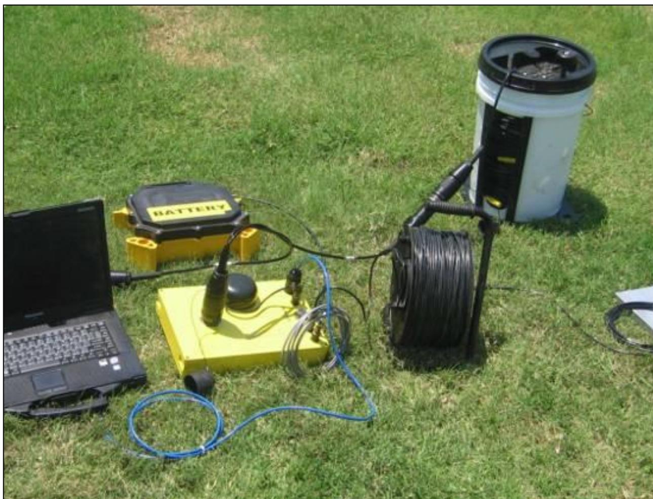
Figura 2.7 - Sismografo DaqLinkIII.
