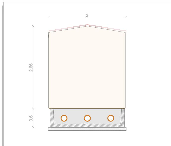
CABINA DI TRASFORMAZIONE - PROSPETTO C
