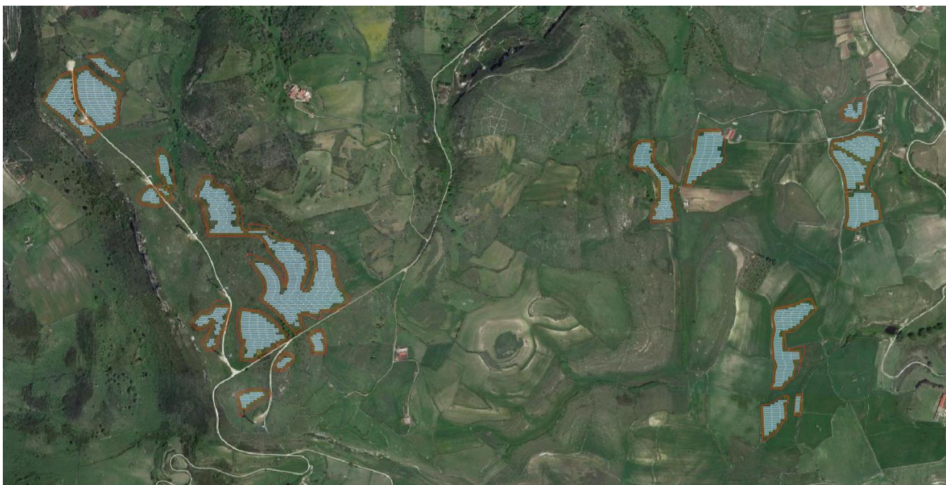
Figura 4.6 - Planimetria dell'impianto agrivoltaico.
