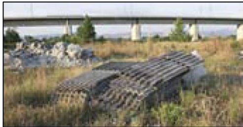
Situazione non regolare: materiale con possibile contenuto di amianto abbandonato sul terreno
