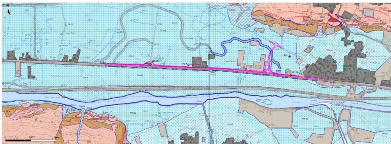
Figura 4-4: Stralcio dalla Carta Geologica di PD della tratta 2-SS38 (la geologia è la stessa presente nella tratta 1: depositi alluvionali grossolani).
