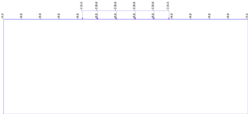
Figura 20: Sovraccarichi verticale da traffico con TS in mezzeria [kN/m]
