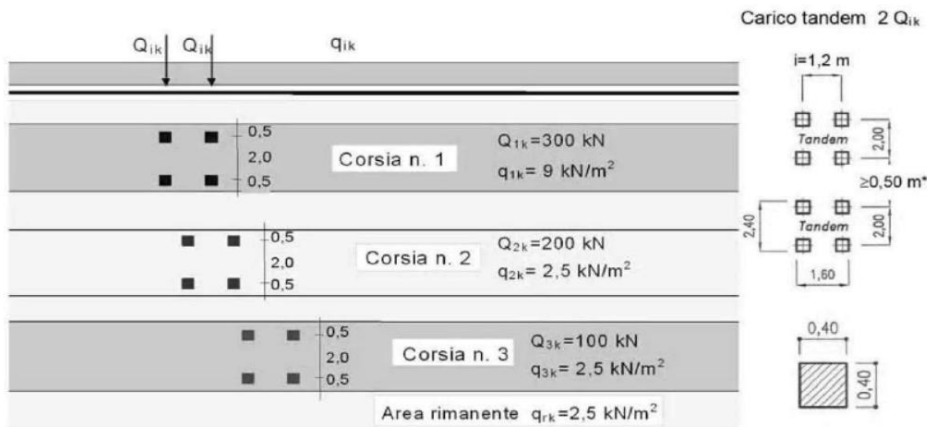
Figura 20: Carichi da traffico secondo NTC18 – Schema di carico 1
