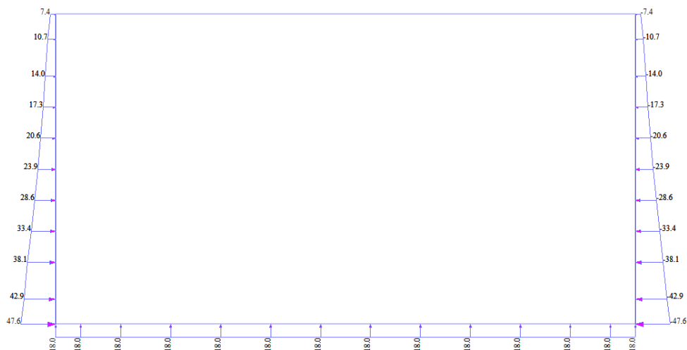
Figura 18: Spinta del terreno + falda [kN/m]
