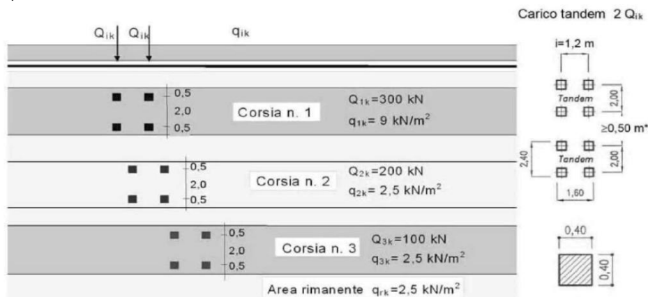
Figura 19: Carichi da traffico secondo NTC18 – Schema di carico 1
