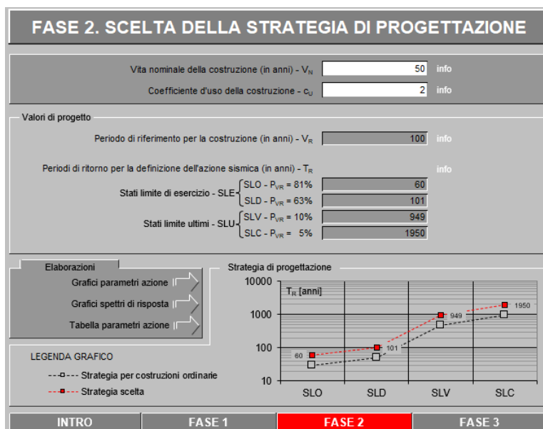
Figura 12: Dati di input (Fase 2) in "Spettri-NTCver.1.0.3"
