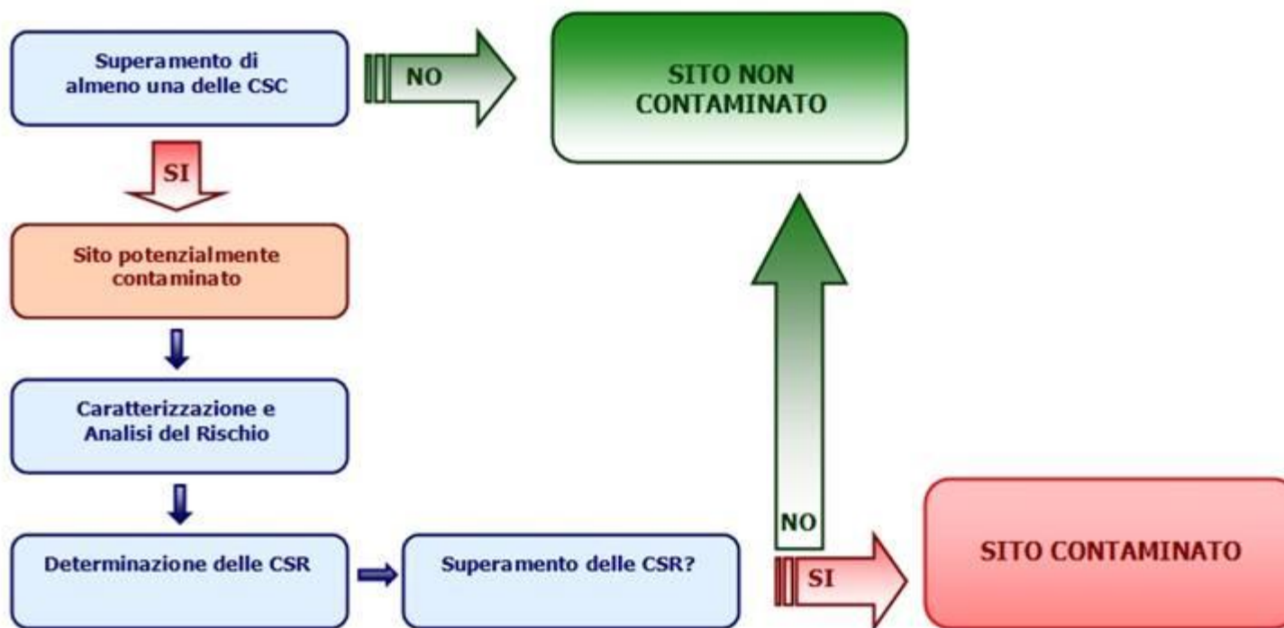
FIGURA 3-1 – SCHEMATIZZAZIONE DELL'APPROCCIO ALLA BONIFICA DEL D.LGS. 152/06
